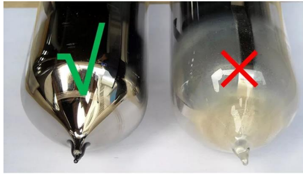
Şekil 3.15. Soldaki tüp hatasız, sağdaki tüp hatalı üretilmiş
