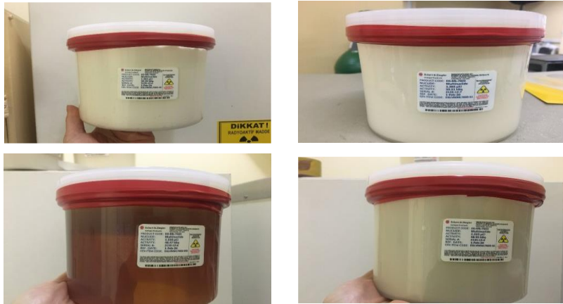
Şekil 3.5. 4 farklı yoğunluktaki Marinelli radyoaktif kaynaklar
