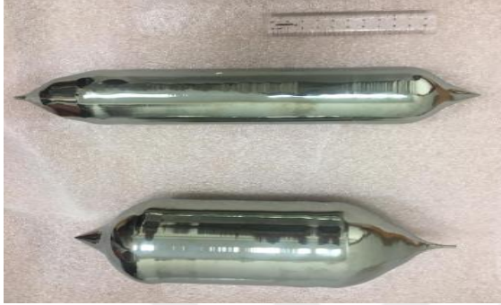
Şekil 2.14. Saf Germanyum üretimi (cetvel 10 cm'dir.) (Gazi Üniversitesi Fotonik Laboratuvarı)
