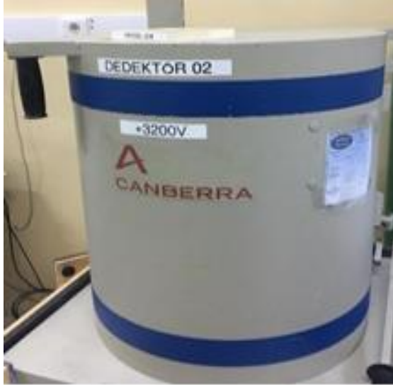
Şekil 3.1. p- tipi koaksiyel HPGe dedektörün (a) karşıdan ve (b) üstten görünümü
