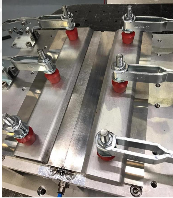
Şekil 3.2. Fikstüre sabitlenmiş, kaynak edilmeye hazır parçalar
