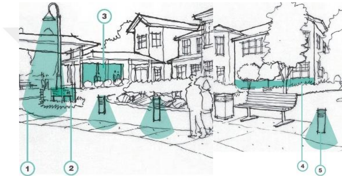
Şekil 42.1. Cut-off aydınlatma, 2. İyi aydınlatılmış yön bulma işaretlemesi, 3. Yapı girişi aydınlatması, 4. Bina aydınlatması 5. Baba yol aydınlatması (Enterprise Green Communities, 2016).
