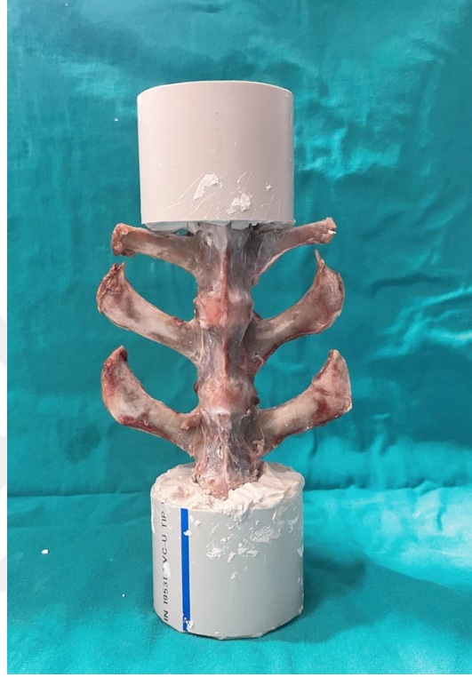
řekil-27: T12-L2 seviyesinde PVC potlarla fıkse edilmiř omurga
