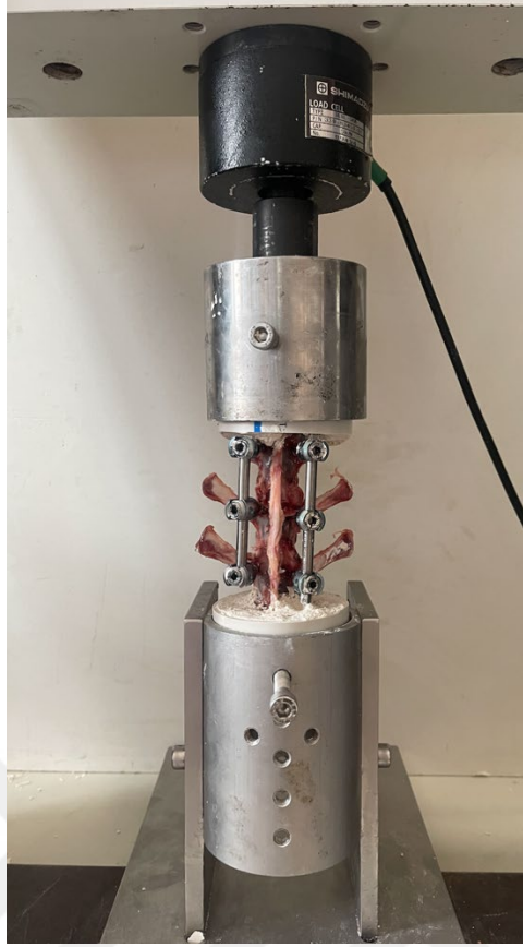
Şekil-33. Fikse edilen koyun omurgalarının aksiyel yüklenme testinde yerleşimi
