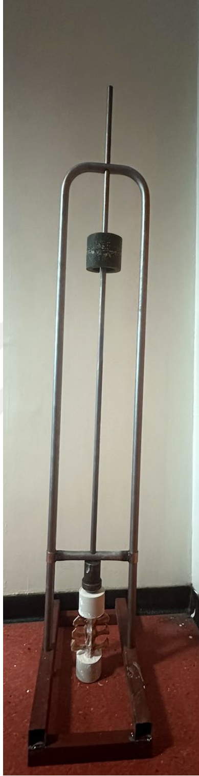
řekil-29: Düşen kütle modeliyle deneysel kırık oluřturma
