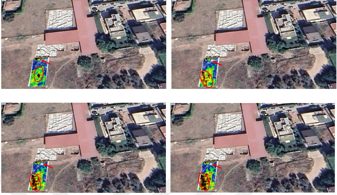
Şekil 3.19 Alanların birleştirilmesinden elde edilen 2-Boyutlu seviye haritalarının uydu görüntüsü (0-1.0 m)
