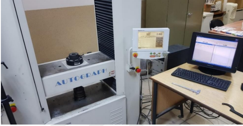
Şekil 2.40 Shimadzu (AG-IS 100kN) çekme-basma cihazı (Kılınç, 2023)
