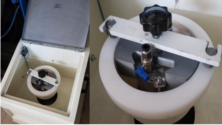
Şekil 2.33 Ser-Mak çalkalayıcı değirmen (Kılınç, 2023)
