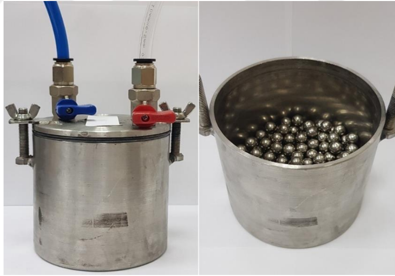
Şekil 2.35 Öğütme işleminde kullanılan kavanoz (Kılınç, 2023)
