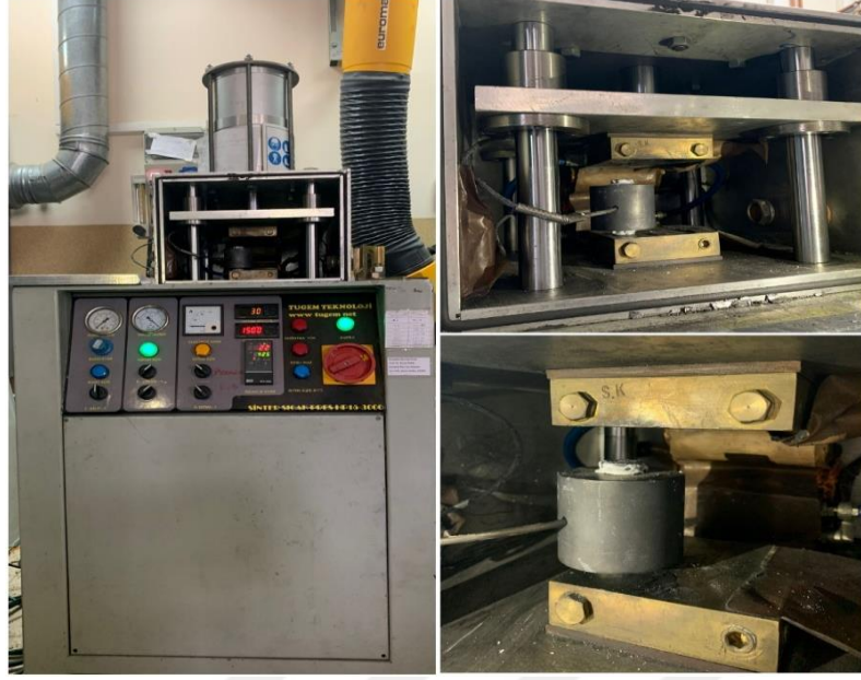
Şekil 2.37 FAST sinterleme cihazı (Kılınç, 2023)
