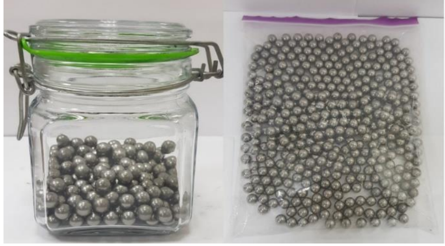
Şekil 2.34 Öğütme işleminde kullanılan bilyeler (Kılınç, 2023)
