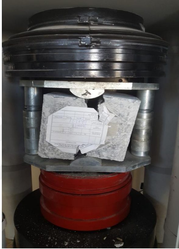
Şekli 3.19 Yarmada çekme deneyi numune kırımı
