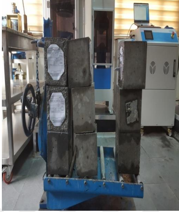
Şekil 3.16 Kür havuzundan çıkarılan numuneler
