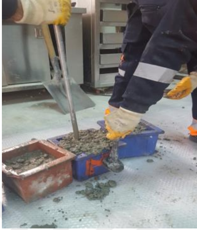
Şekil 3.15 Harcın küplere yerleştirilmesi
