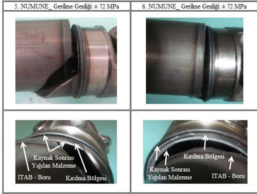
Şekil 2.23 Kaynaklı bağlantılara ait yorulma kırılması ( \pm 72 MPa)
