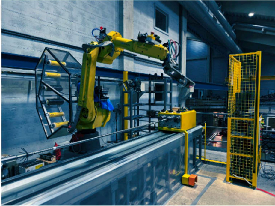
Şekil 3.13 Filaman sarım makinası (Compo Tech Plus, 2023)
