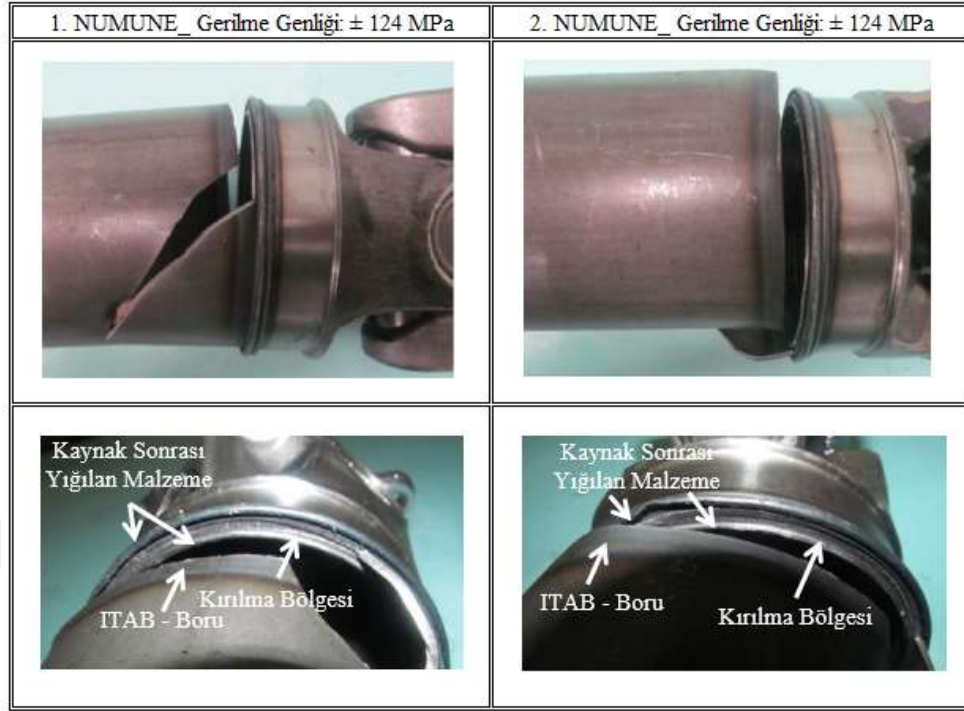
Şekil 2.21 Kaynaklı bağlantılara ait yorulma kırılması ( \pm 124 MPa)
