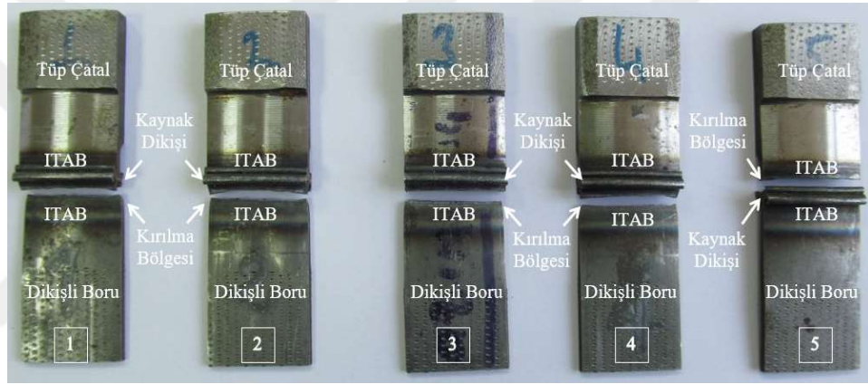
Şekil 2.12 Çekme testi sonrasında numunelerin genel görünümü
