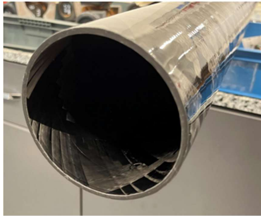
Şekil 3.15 Karbon fiber takviyeli kompozit boru kesit görüntüsü
