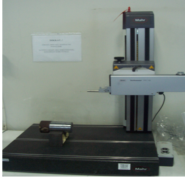
Şekil 3.7 Yüzey Pürüzlülüğü Ölçmede Kullanılan Araç Perthometer
