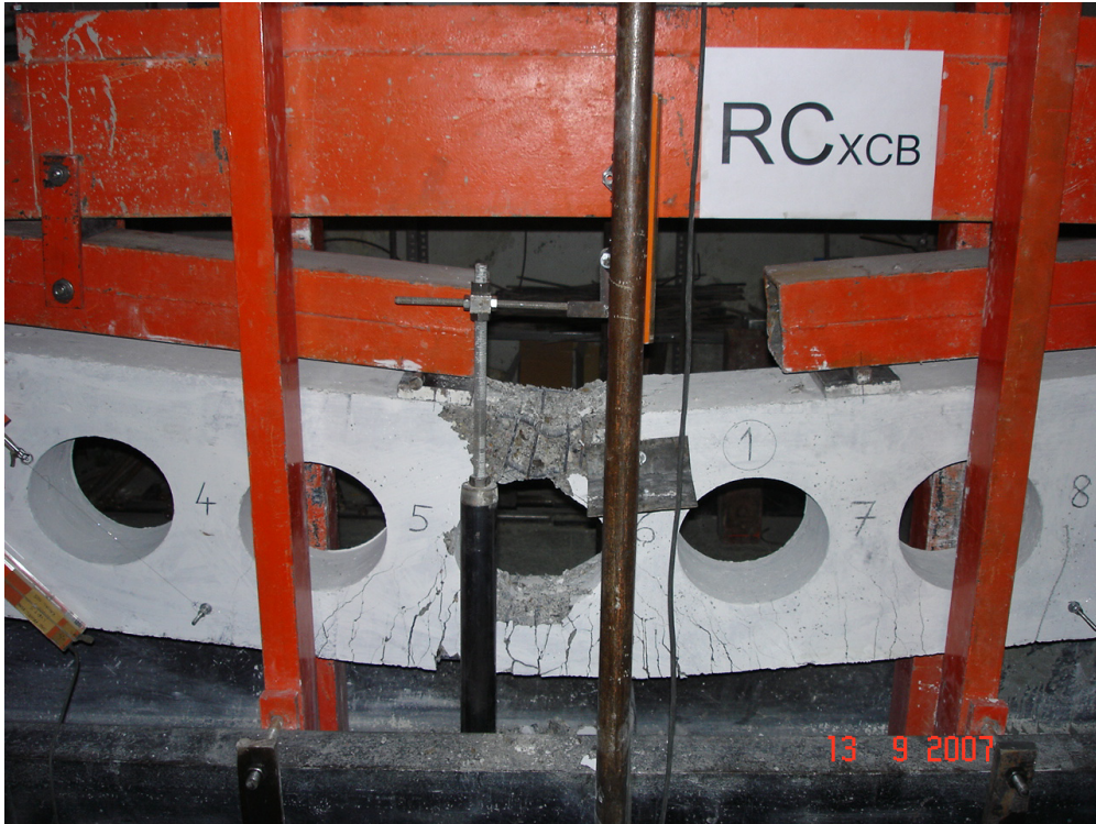
Resim 4.20. RCxcb kirişı deney sonrası görüntüsü
