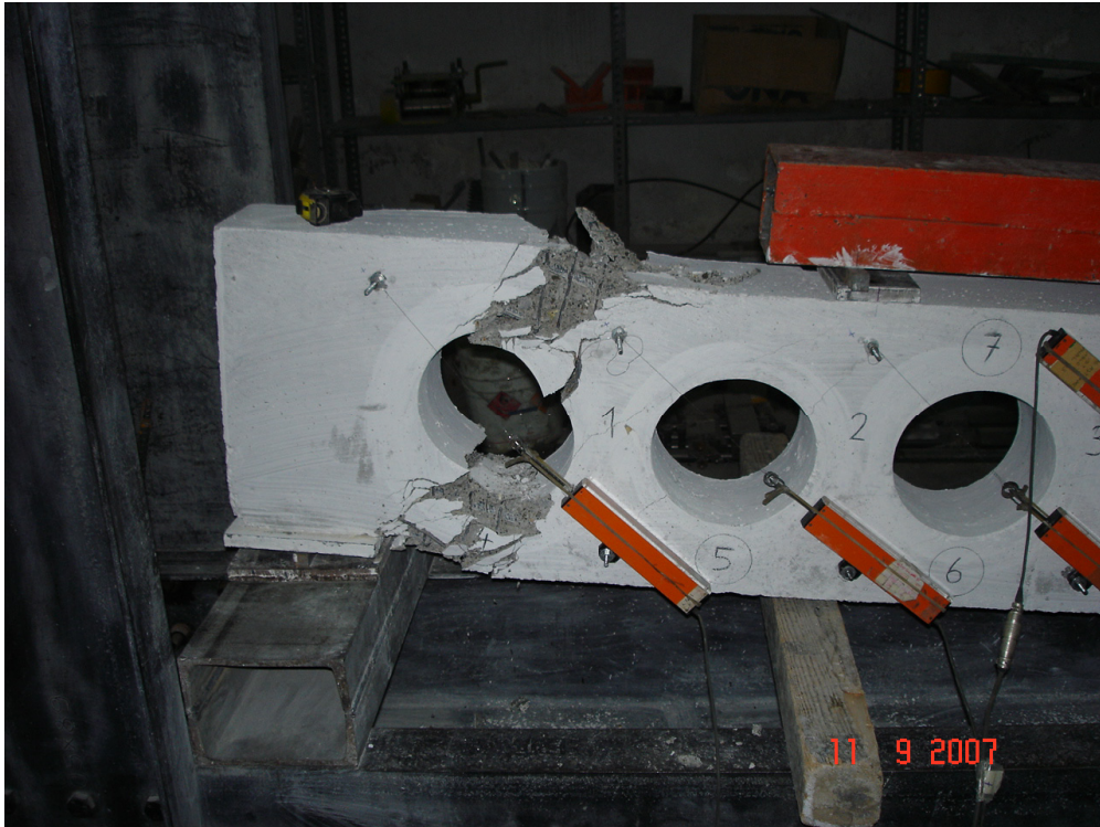
Resim 4.14. RCb kirişı deney sonrası görüntüsü
