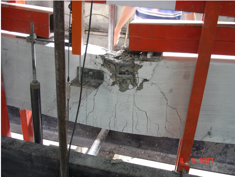
Resim 4.4. RBb kirişı deney sonrası görüntüsü
