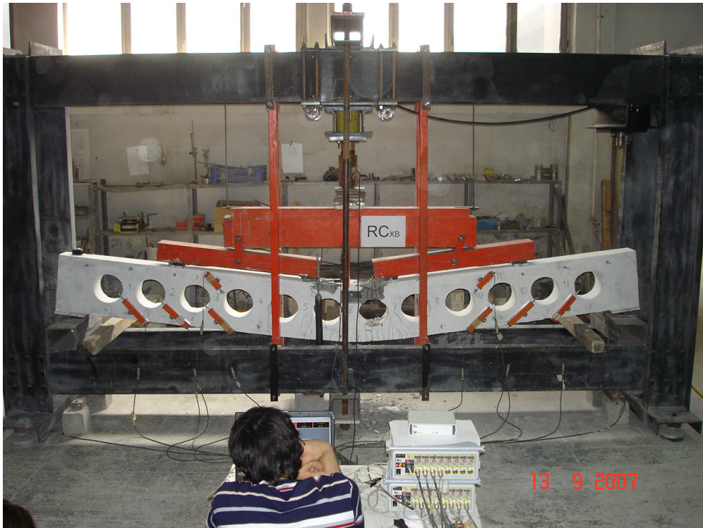
Resim 4.18. RCxb kirişı deney sonrası görüntüsü
