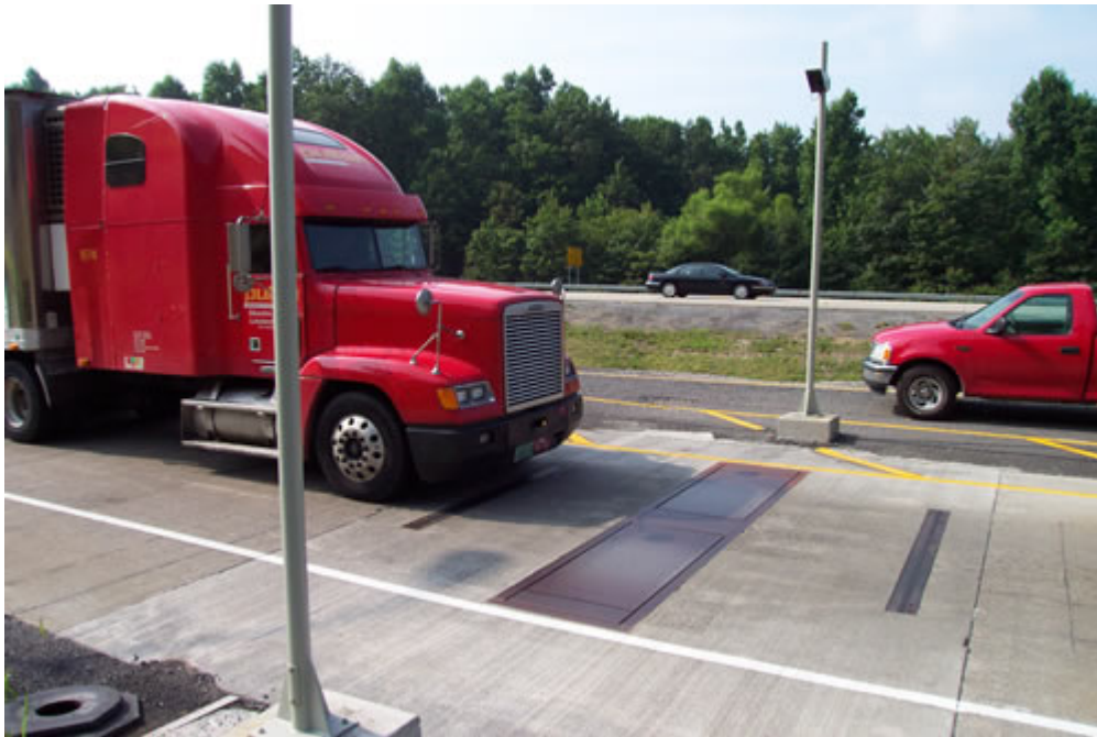
Resim 2.3. Anayol üzerindeki WIM istasyonuna yönlendirilen araçların sensör geçişleri ve tartımı [1]
