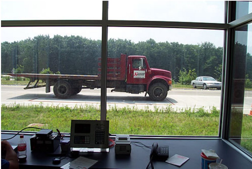
Resim 2.7. Anayol üzerindeki WIM istasyonundaki durgun şerit [1]
