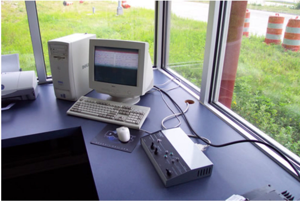
Resim 2.9. Anayol üzerindeki WIM istasyonundaki ölçüm yapılan araçların verilerinin bilgisayara aktarılması
