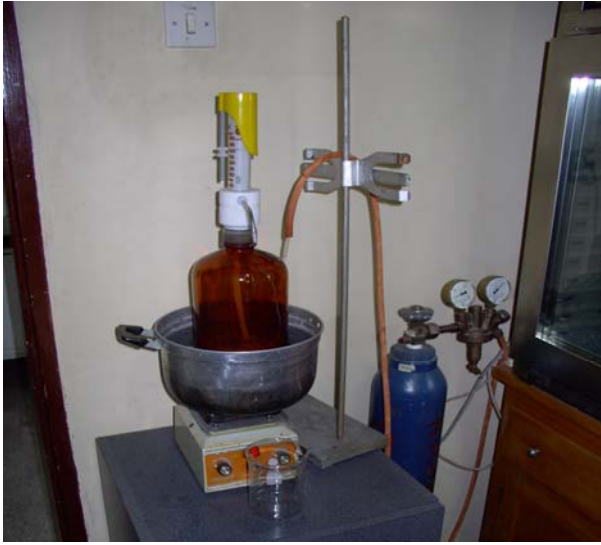
Resim 3.6. Otomatik pipet ve 2 l'lik Woulf şişesi. Manyetik karıştırıcı, su banyosu (39 °C'ye ayarlı) ve karbondioksit tüpü
