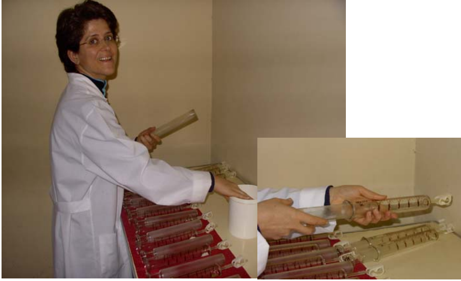
Resim 3.3. Ölçü silindiri pistonlarının vazelinlenmesi ve içine yerleştirilmesi
