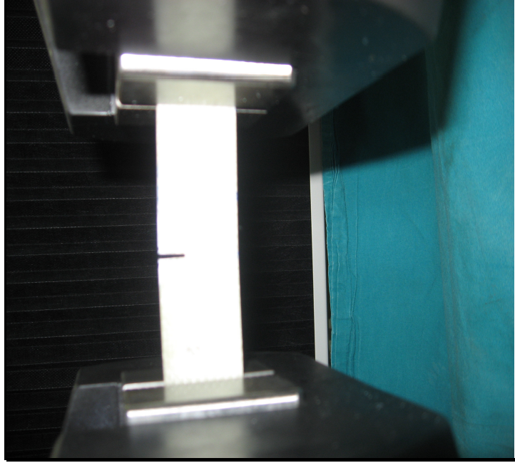
Şekil 4.37 Numunenin çenelere bağlanıp deney başlangıç hali.
