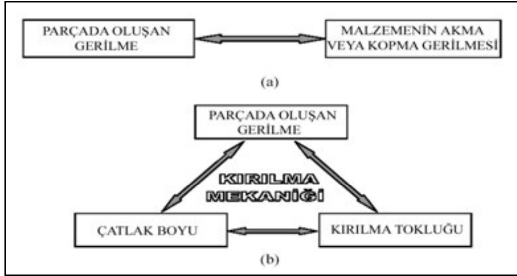
Şekil 3.3 Ürün tasarımı için klasik yaklaşım ile kırılma mekaniği yaklaşımı.
