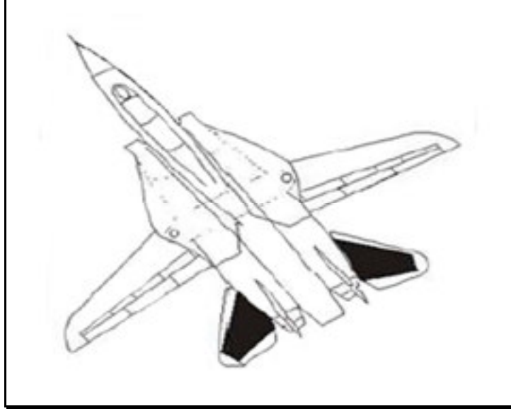
Şekil 2.4 F14 ve F15 uçaklarındaki yatay ve dikey dengleyiciler.
