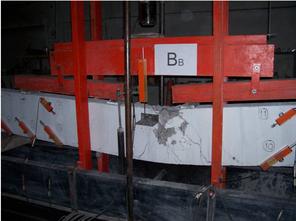
Resim 5.9. B B kirişinin deney sonrası görüntüsü
