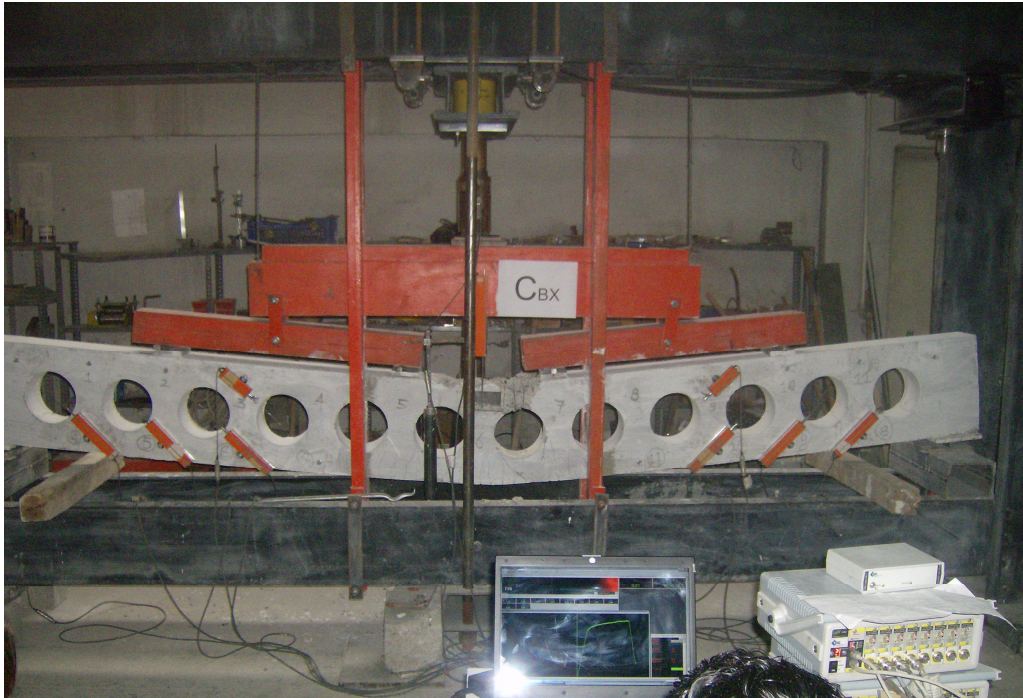
Resim 5.12. C_{BX} kirişinin deney sonrası görüntüsü
