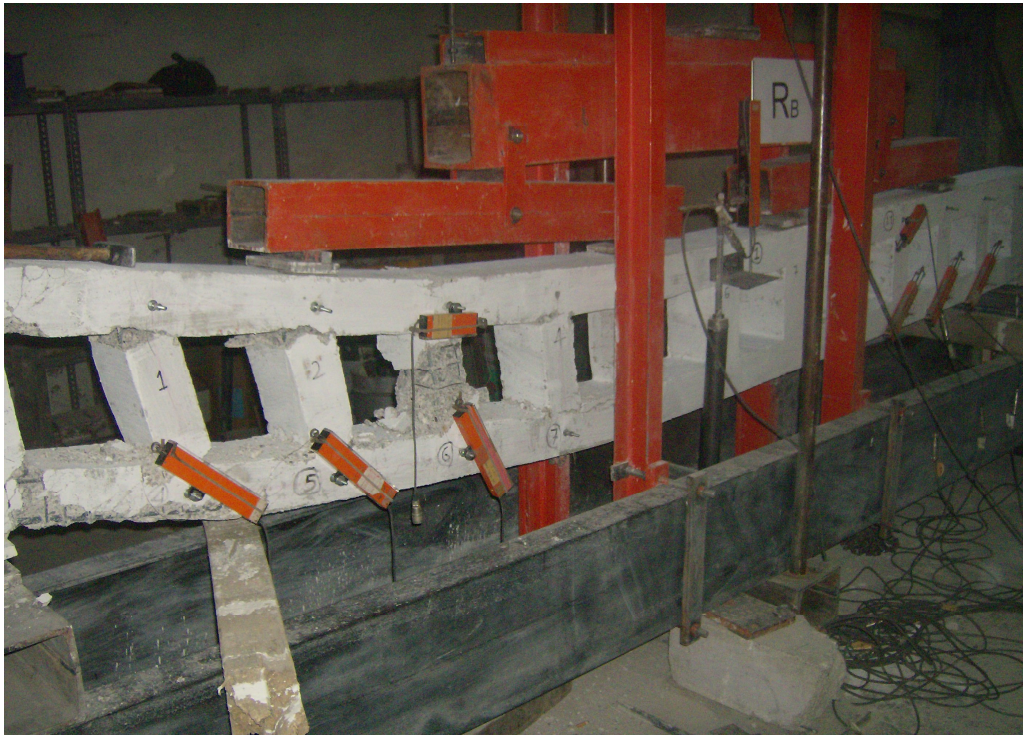
Resim 5.11. R_B kirişinin deney sonrası görüntüsü
