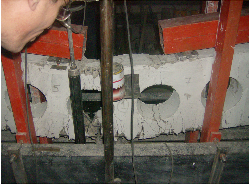
Resim 5.3. Deney sonrası C SX kirişi görüntüsü
