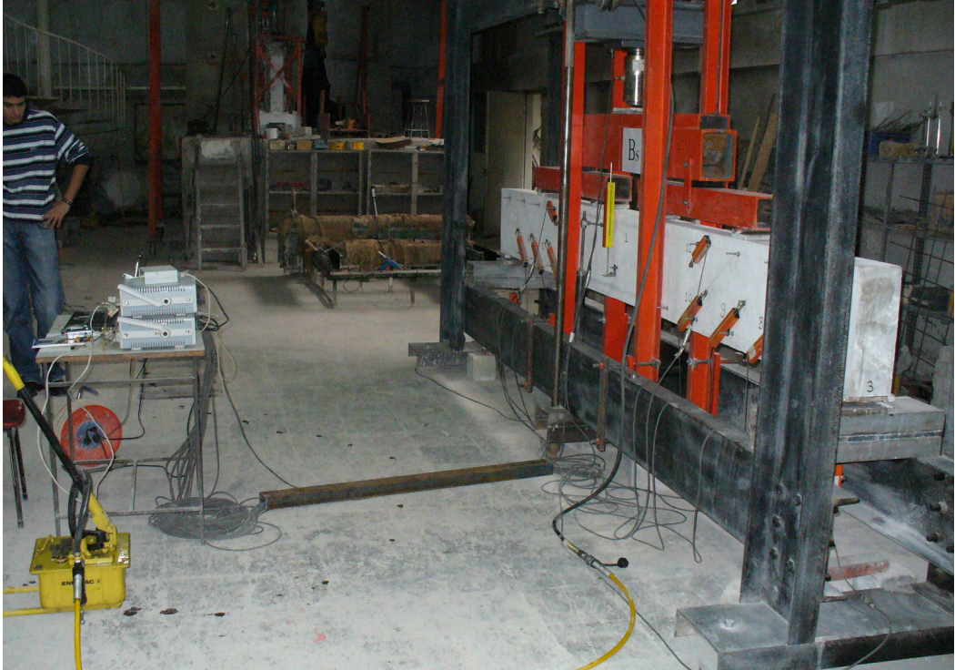
Resim 4.4. LVDT' leri, Data Loader' a bağlanmış, deneye hazır bir kiriş
