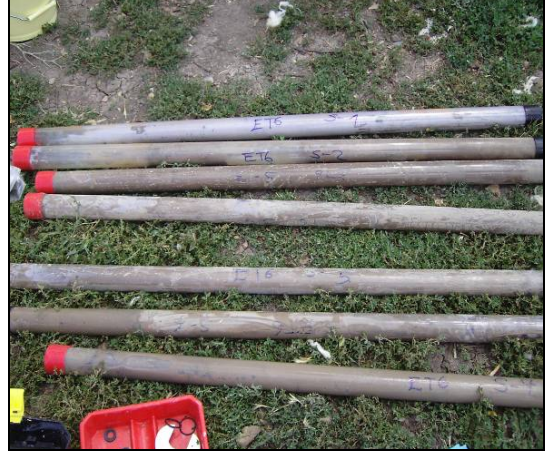
Foto 3.2. Sondaj kuyularından plastik koruyucular ile toprak örneklerinin alınması ve yüzeyden itibaren inilen derinlik sırasına göre örneklerin kodlanması işlemi.
