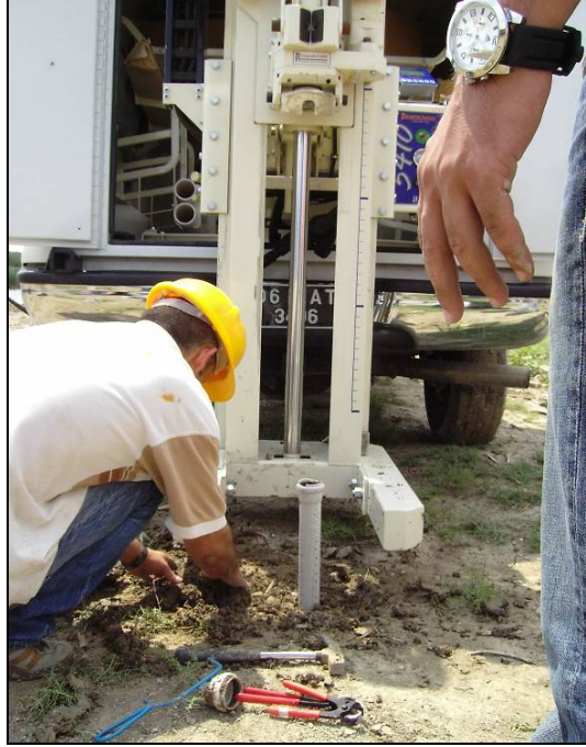
Foto 3.3. Arazide açılan sondaj kuyularına YAS değişimini gözlemek amacı ile PVC borularının yerleştirilmesi.
