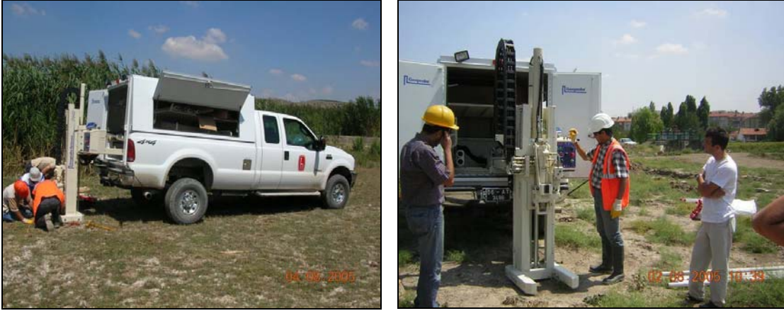
Foto 3.1. Geoprobe sistemi ve inceleme alanında yapılan sondaj çalışmaları.
