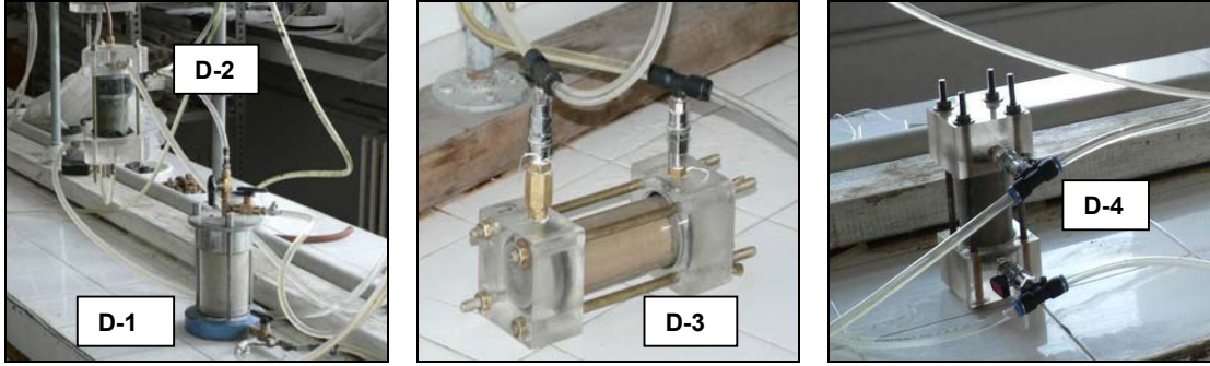
Foto 3.5. Hidrolik iletkenlik katsayısının belirlenmesinde kullanılan kolon düzenekleri.
