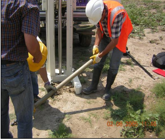
Foto 3.2. Sondaj kuyularından plastik koruyucular ile toprak örneklerinin alınması ve yüzeyden itibaren inilen derinlik sırasına göre örneklerin kodlanması işlemi.
