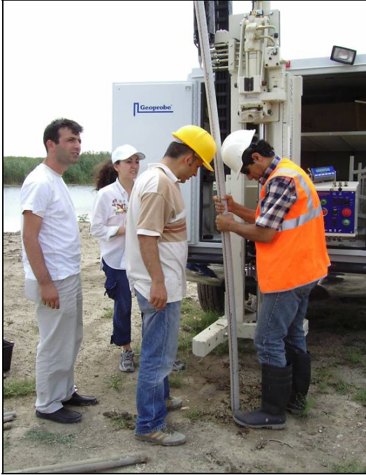
Foto 3.3. Arazide açılan sondaj kuyularına YAS değişimini gözlemek amacı ile PVC borularının yerleştirilmesi.
