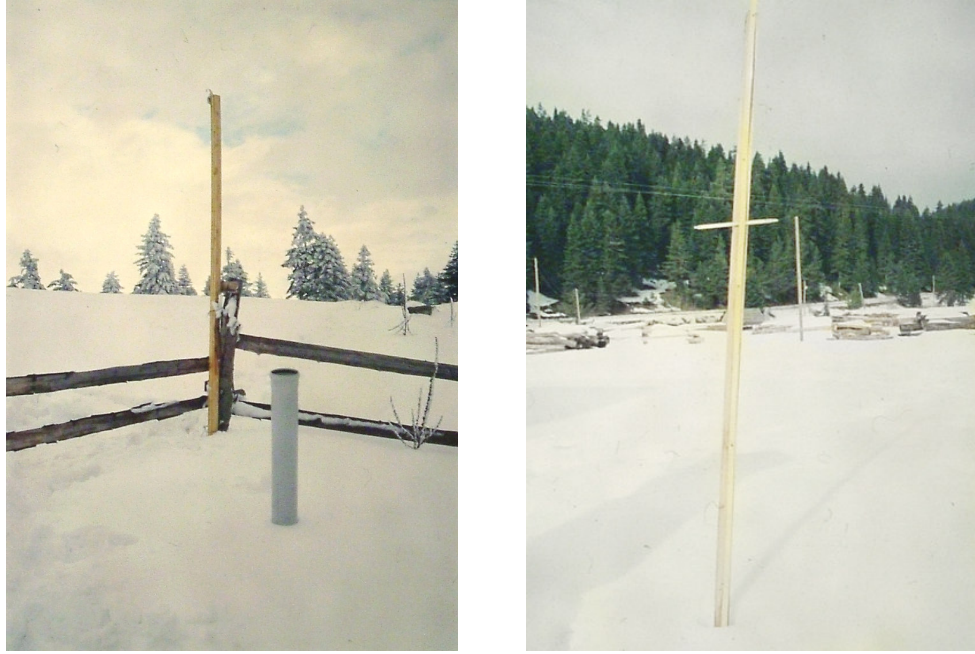
Şekil 3.12 : Kar yağışı derinlik ölçümlerinde kullanılan sabit eşeler
