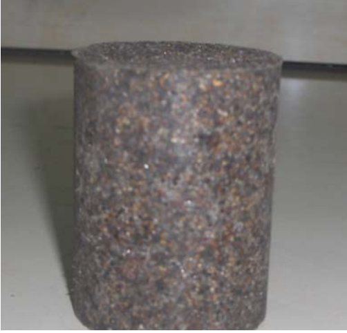
Resim 4.6. Model 2’de anakayayı temsil eden “silikon-kum karışımı” malzemesinin karot numunesi
