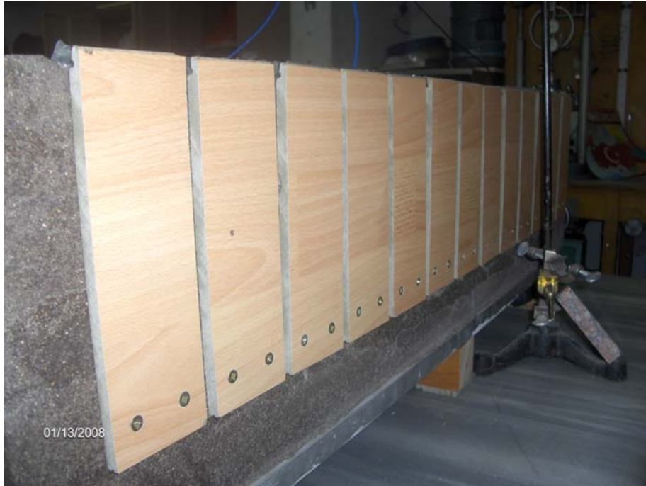
Resim 4.7. Model 2’de MDF malzeme ile yan duvarlara uygulanan yöntem
