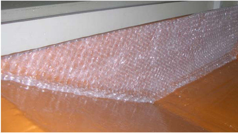
Resim 4.5. Model 1’de alçıpan yan duvarlara kaplanan PVC ambalaj malzemesi
