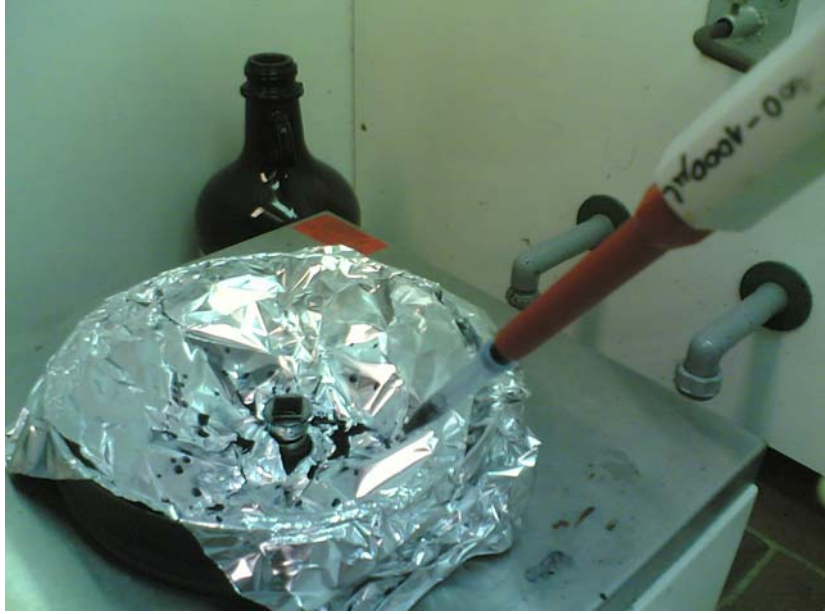
Şekil 2.12. Döndürme kaplama yöntemi ile oluşturulan ince film tabaka
