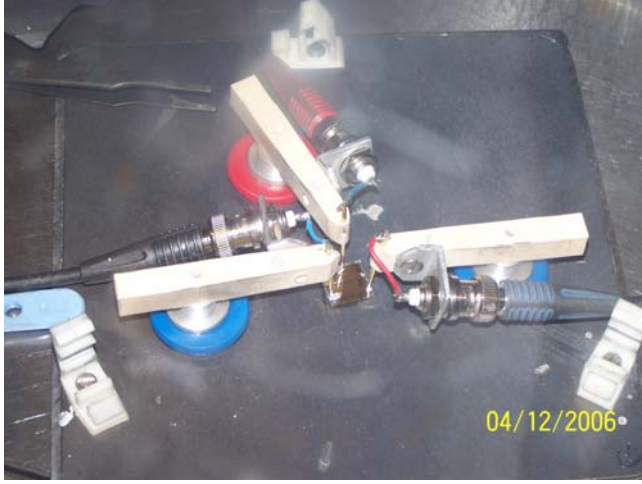
Şekil 3.7. Fulleren ( C_{60} ) kullanılarak oluşturulan OFET'in elektriksel ölçüm alınırken çekilmiş fotoğraf (Linz/Johannes Kepler üniversitesi)
