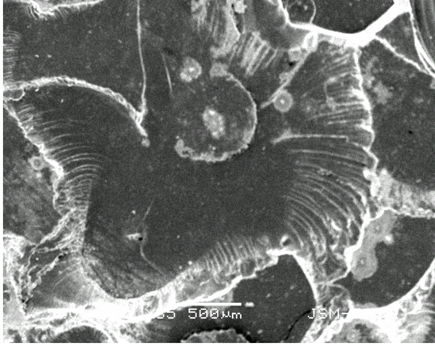
Şekil 4.59: İz oluşumu deneyi sonrası ağırlıkça % 0.5 tinal katkılı örneğe ait SEM görüntüsü (Büyütme 35 kat)
