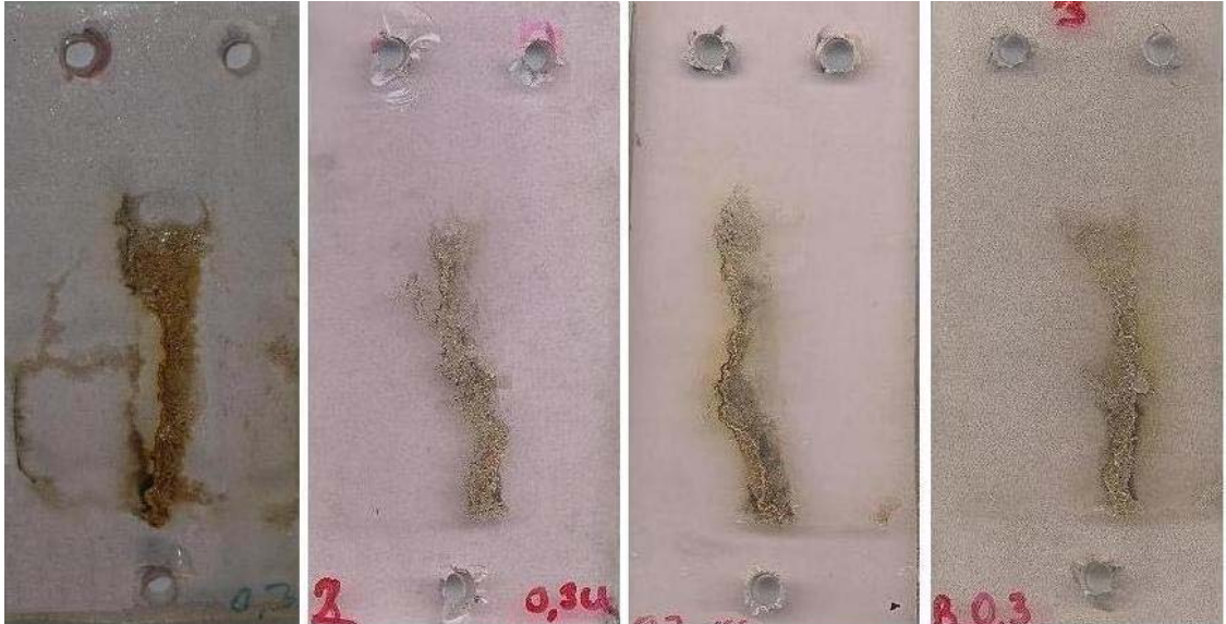
Şekil 4.2: Ağırlıkça % 0.3 oranında farklı bor mineralleri ile hazırlanan örneklerden birinin yüzeyde iz oluşumu deneyi sonrası görüntüleri
