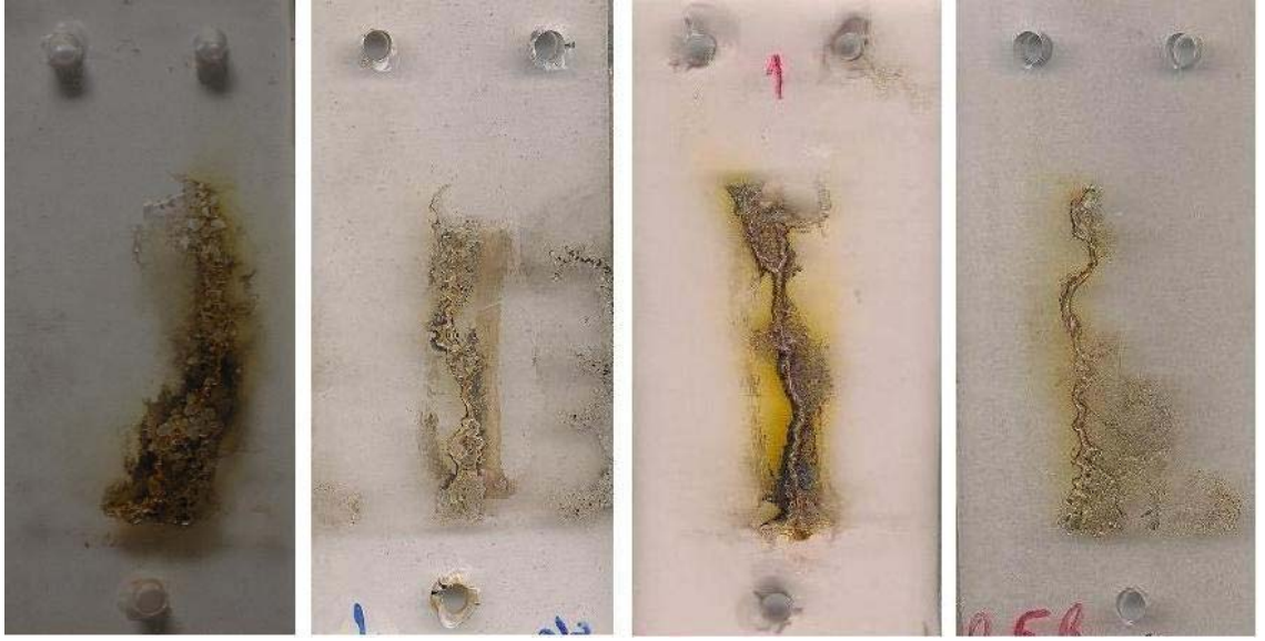
Şekil 4.6: Ağırlıkça % 0.5 oranında farklı bor mineralleri ile hazırlanan mekanik titreşim etkisi ile yorulmuş örneklerden birine ait iz oluşumları.
