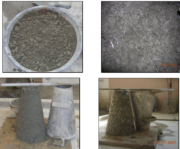
Şekil 5.20. Kontrol ve %0,75 polipropilen lifli karışımların kıvamına ait fotoğraf
