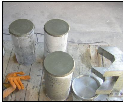
Şekil 5.23. 150/300 mm ayrıtlı silindir numunelerde tek taraflı kükürt başlık
