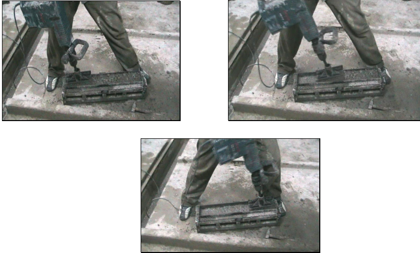
Şekil 5.21. 100/100/600 mm ayrıtlı prizmatik numune elde etmek için sıkıştırma işlemi (sağdan sola 1 pas geçiş)
