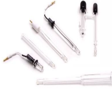
Şekil 3.4 BAS Model Ag/Ag + elektrotlar (içinde asetonitril içinde 0,1 M TBATFB olan dolgu çözeltisi)
