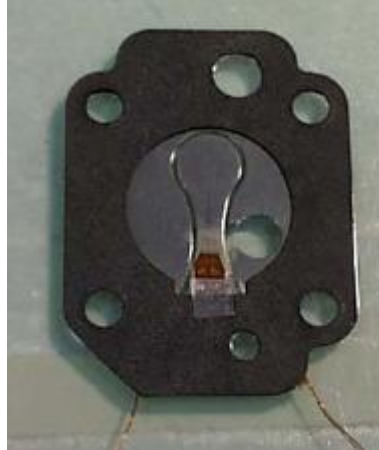
Şekil 4.20 Emme valf yaprağına SG yapıştırılması için örnek uygulama
