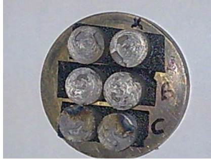
Şekil 3.26. SEM görüntüleri için hazırlanan numuneler
