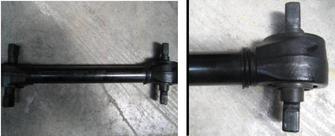
Şekil 2.11. Ticari araçlarda sürtünme kaynağı uygulanmış çeki kolları
