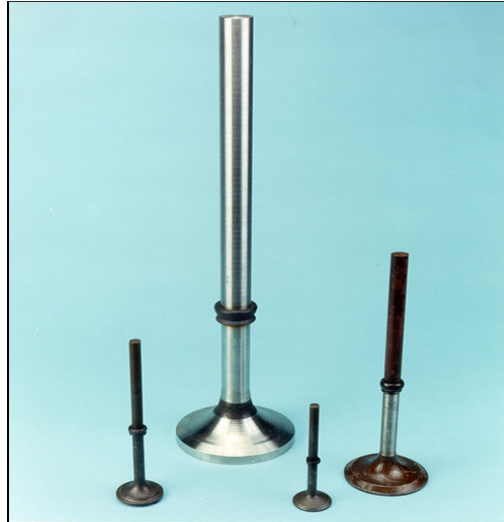
Şekil 2.9. Sürtünme kaynağı ile imal edilmiş egzoz supapları [34]
