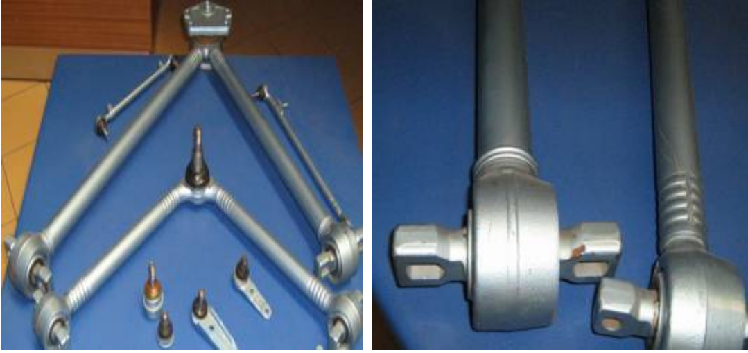
Şekil 2.10. Ticari araçlarda kullanılan, sürtünme kaynağı ve sıcak presleme uygulanmış “V” çeki kolları
