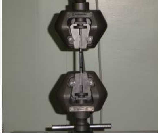
Şekil 3.9. Çekme numunelerinin cihazın çenelerine bağlanması
