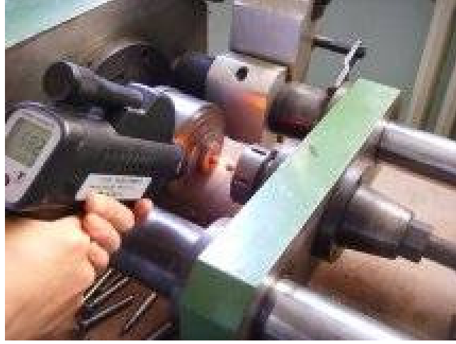
Şekil 3.7. Kızılötesi sıcaklık ölçme cihazıyla yüzey sıcaklık ölçümü
