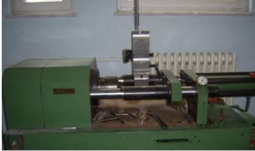
Şekil 3.1. Deneylerde kullanılan sürtünme kaynağı cihazı
