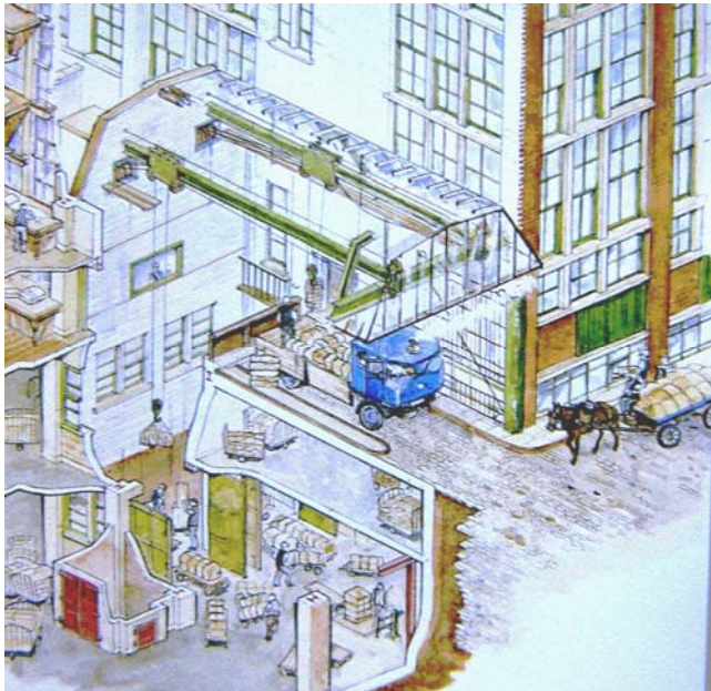
Şekil 4.4. Ticari depolardan olan Asia House yapısında katlar arasında vinçlerle yükleme ve boşaltmanın yapılması [Taylor ve ark.,2002]
