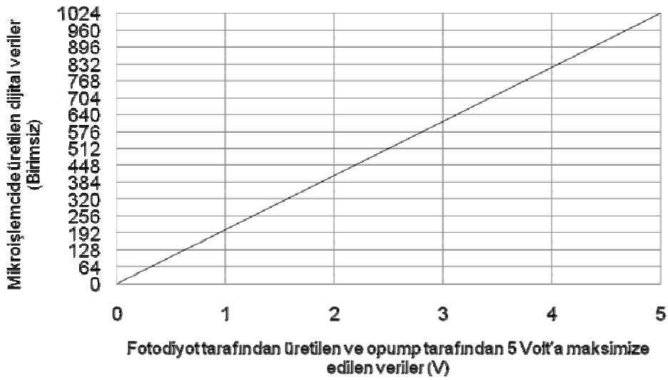
Şekil 3.11. Mikroişlemci tarafından üretilen veriler – ham Voltaj değerleri karşılaştırması.
