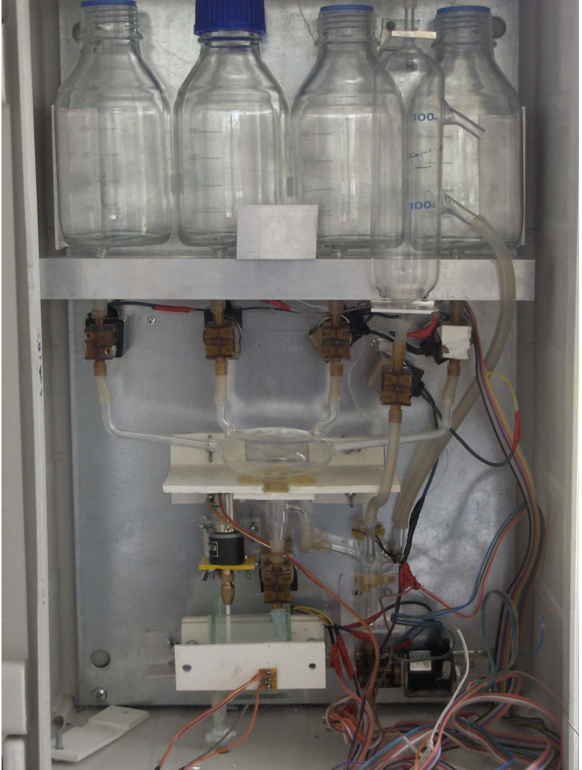
Şekil 3.9. Geliştirilen otomatik analiz sisteminin görünümü.
