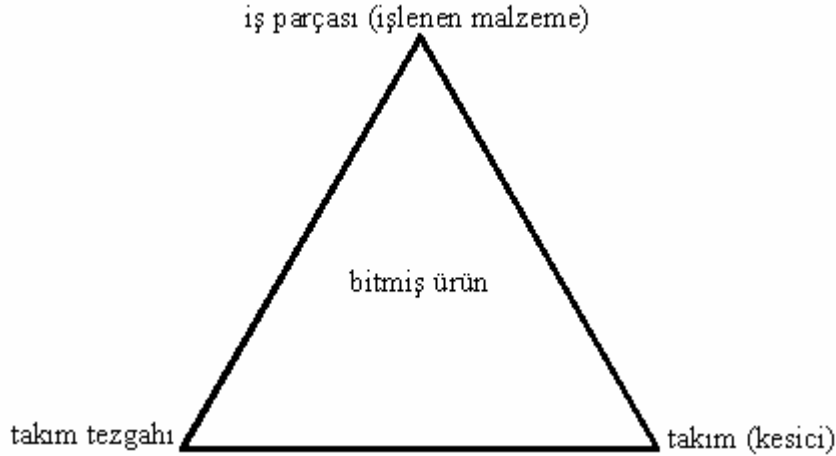
Şekil 1.1. Takım tezgâhı–takım–iş parçası ilişkisi [1]
