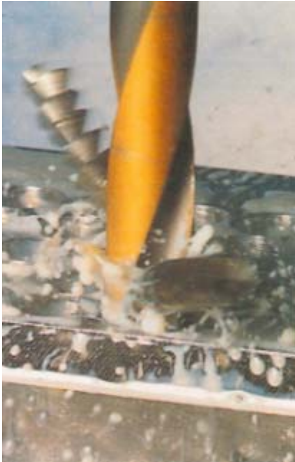
Şekil 3.1. Delik delme işlemi [62].
