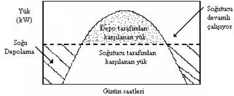
Şekil 2.2. Yük Seviyelemeli Kısmi Depolama.
