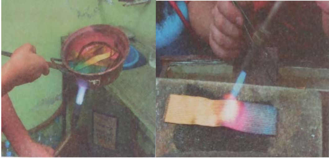
Fotoğraf 8. Hasır Örgünün zaç Yağında Temizlenmesi ve Şaloma ile Tavlanması (megep,2007:28)
