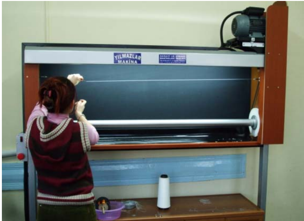
Fotoğraf 18. Elektrikli Çıkrıkta Tel Sarımı
