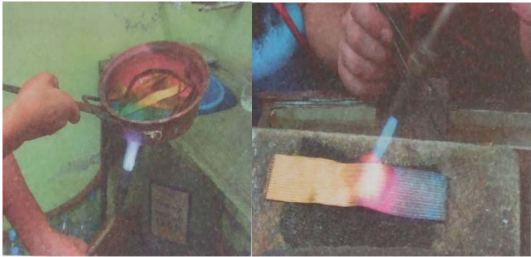
Fotoğraf 8. Hasır Örgünün zaç Yağında Temizlenmesi ve Şaloma ile Tavllanması (megep,2007:28)
