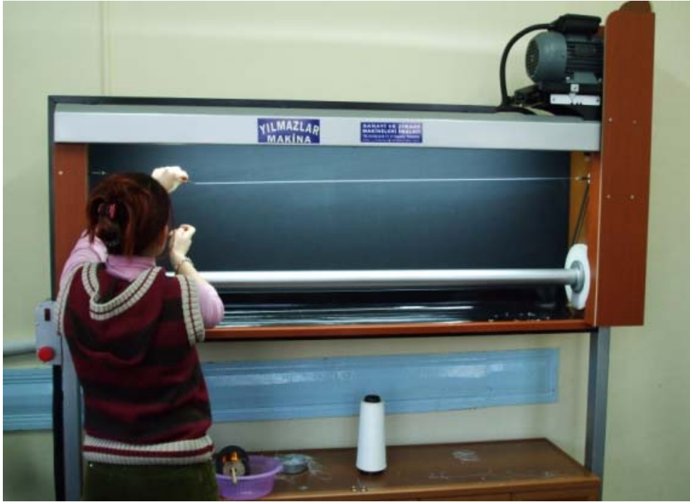
Fotoğraf 18. Elektrikli Çıkırıkta Tel Sarımı
