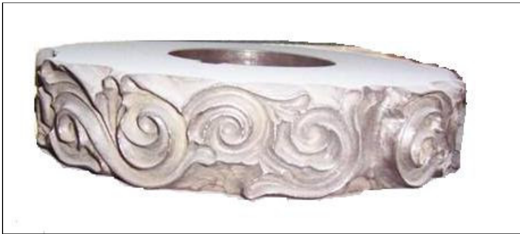
Resim 5.14. Çok derinlikli oyma yapan bıçak [28]
