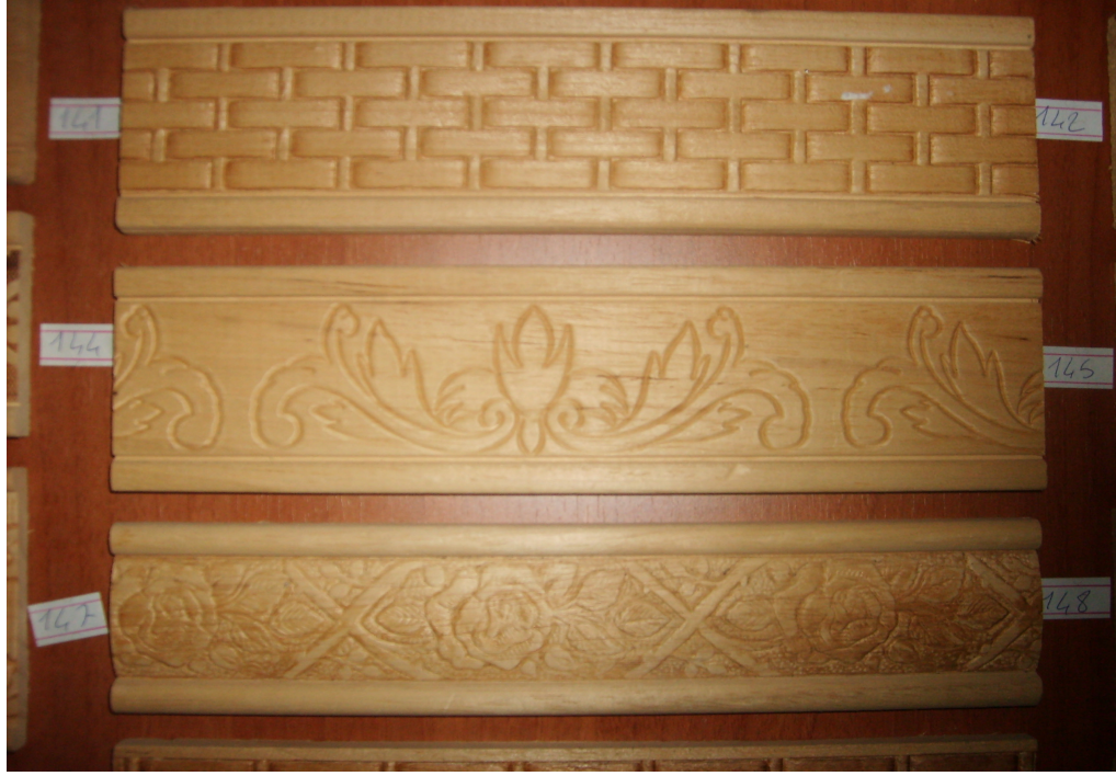
Resim 5.25. Ayous ağacına yapılmış az derinlikli oymalar [28]
