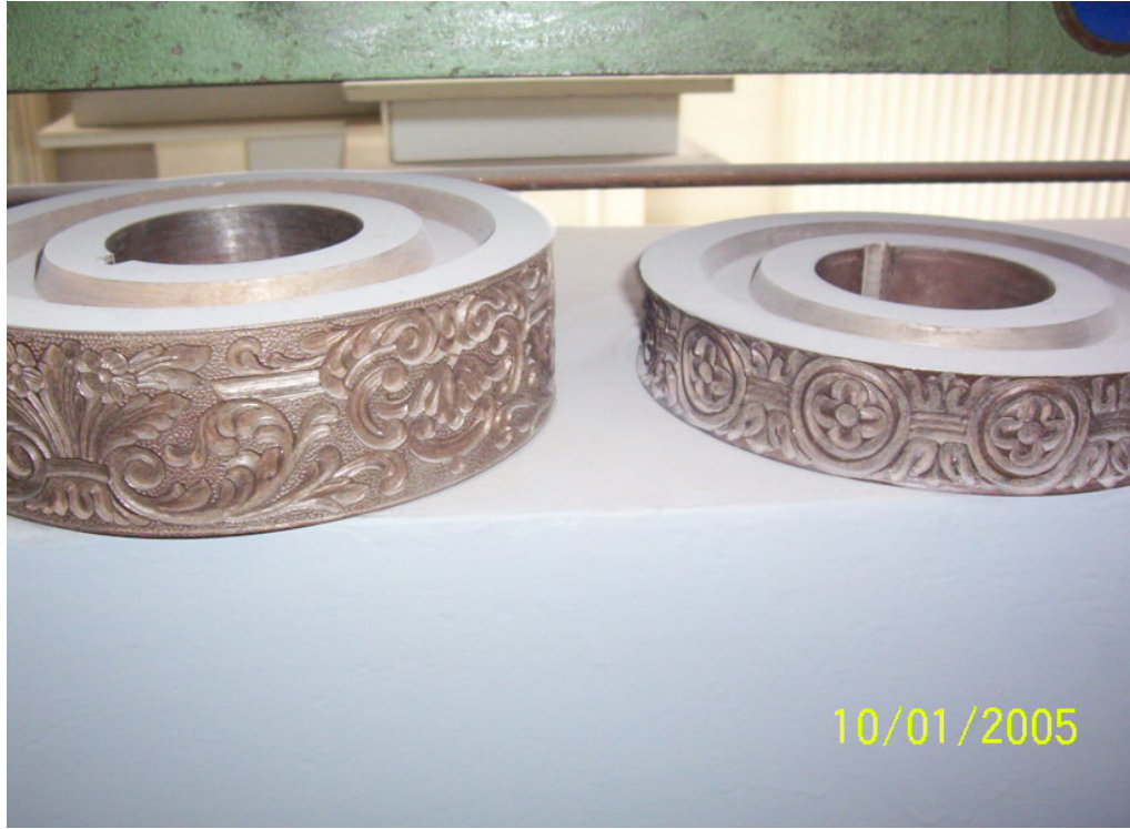
Resim 5.22. Az derinlikli oyma yapan bıçaklar [28]
