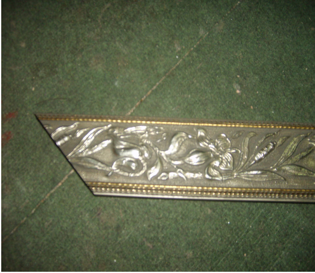
Resim 5.21. Çok derinlikli macunla yapılan oyma, altın ve gümüş varak boyalı [28]
