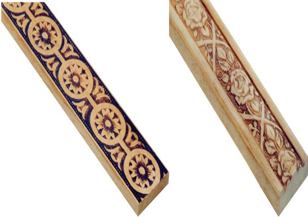
Resim 5.11. Ahşap malzemedede yakma [25]
