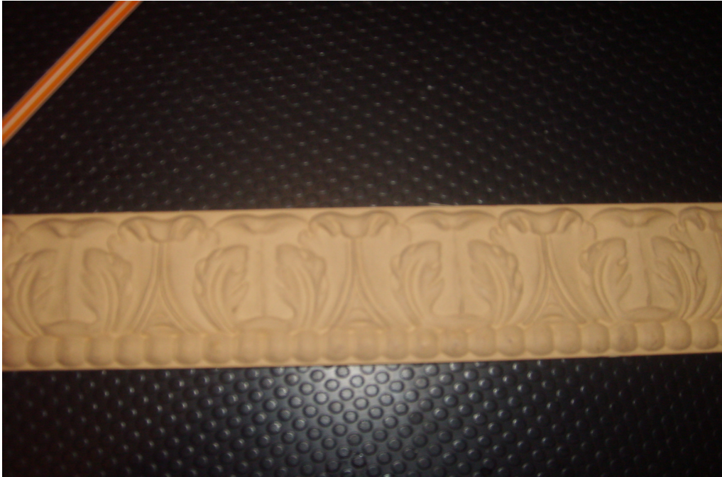
Resim 5.30. Kayıtlarda kullanılan macunla yapılan oyma [28]
