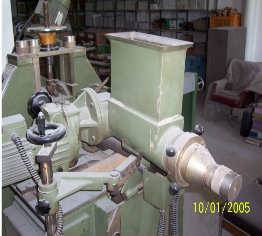
Resim 5.5. Baskı (pres) makinesi macun haznesi [28]
