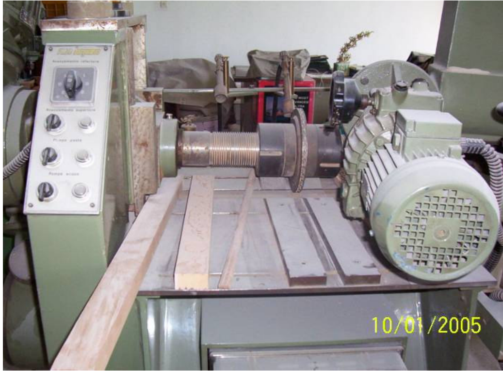
Resim 5.4. Baskı (pres) makinesi sipir ve tezgahı [28]
