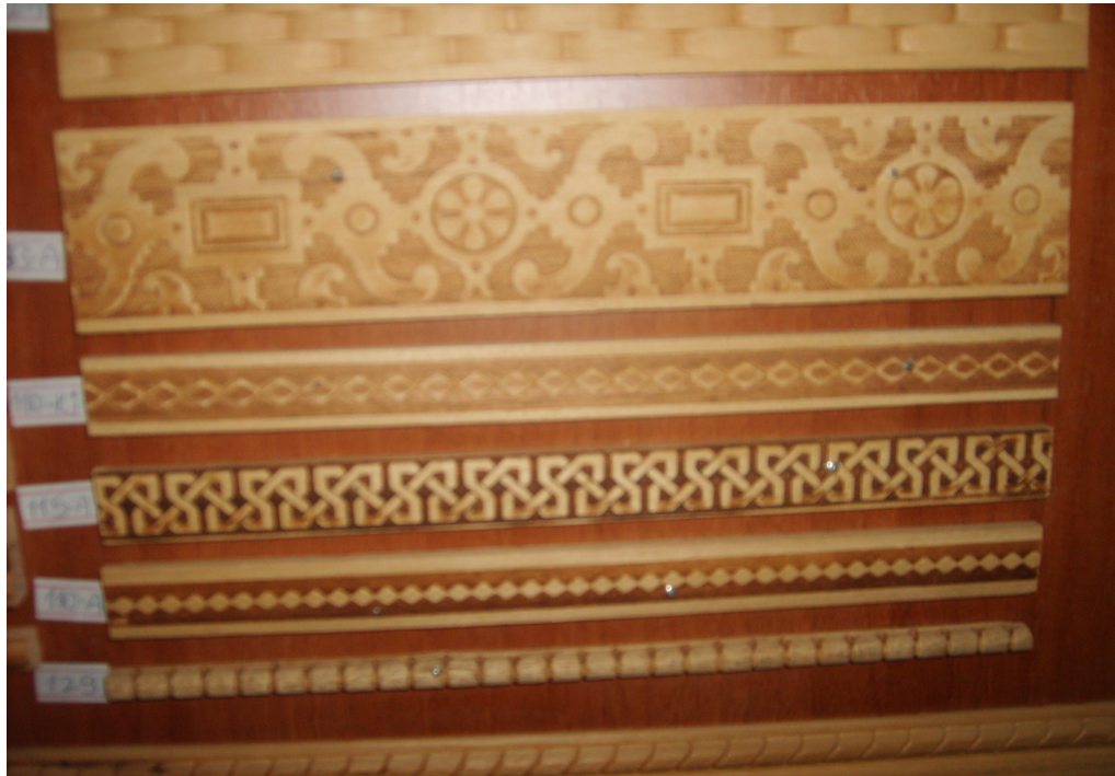
Resim 5.26. Ayous ağacına değişik motifli yapılmış az derinlikli oymalar [28]
