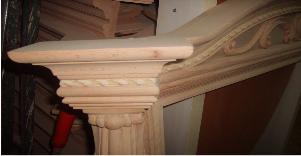
Resim 5.28. Yatak başlıklarında macunla yapılan oyma resmi [28]
