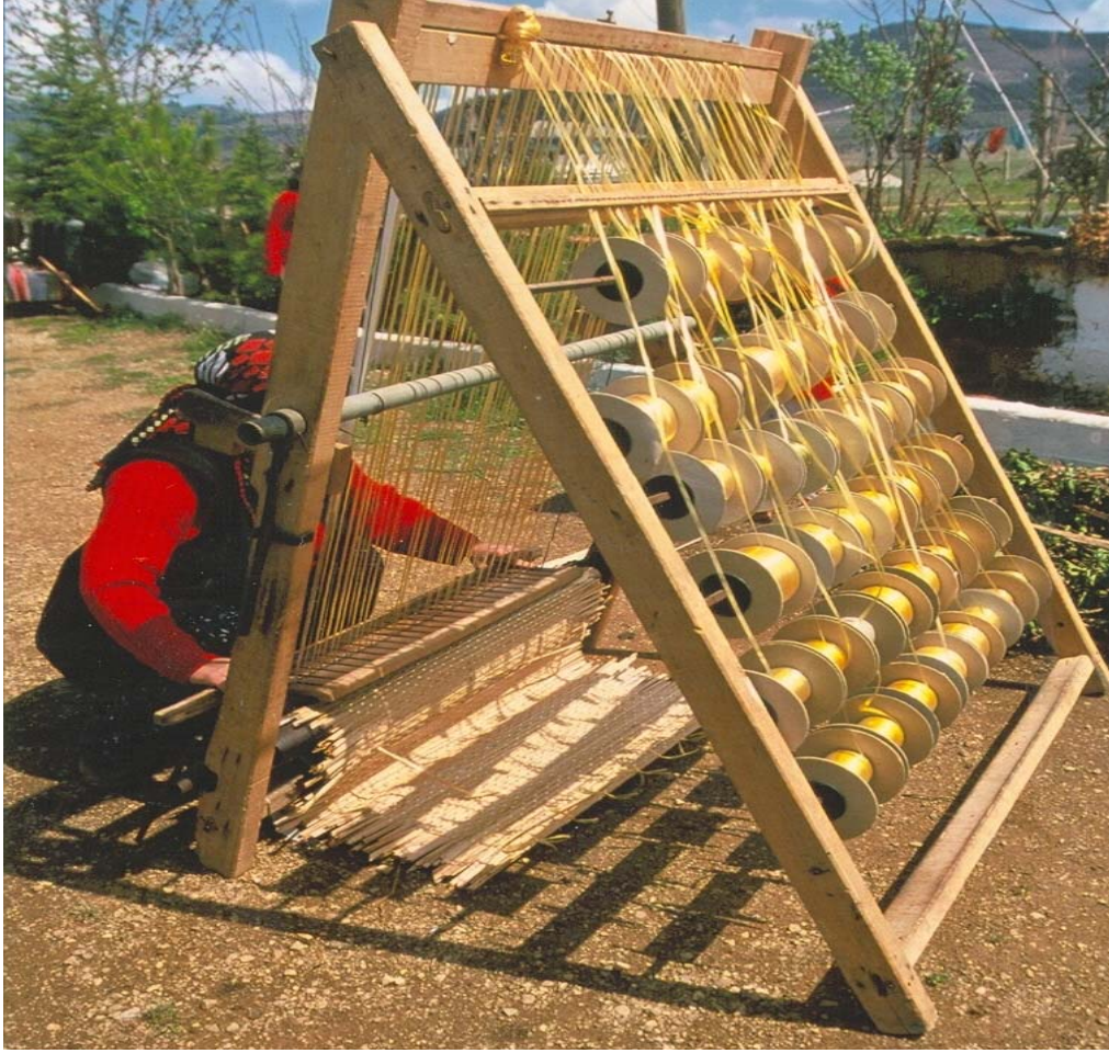
Şekil 4.24 Ahşap taşınabilir dikey tezgah (tak-tak tezgah) (Mutlu Köyü/ Hüyük)
