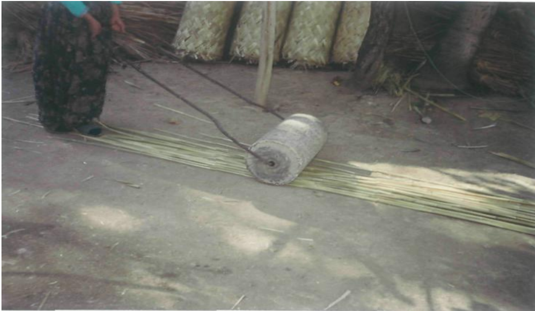
Şekil 4.37“Yurgu taşı” ile yarma işlemi (Doğrugöz Beldesi / Akşehir)
