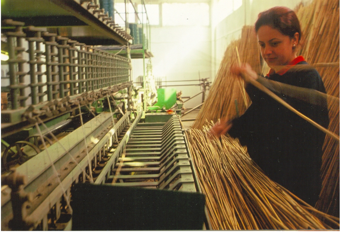
Şekil 4.80 Otomatik tezgahta ipli boyra dokuma işlemi (Doğrugöz Beldesi / Akşehir)
