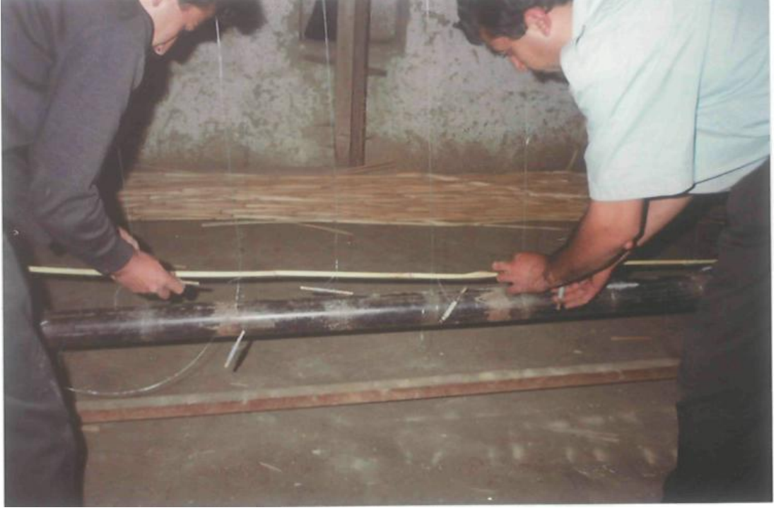
Şekil 4.47 Telli boyra başlangıç işlemi (1) (Doğrugöz Beldesi / Akşehir)
