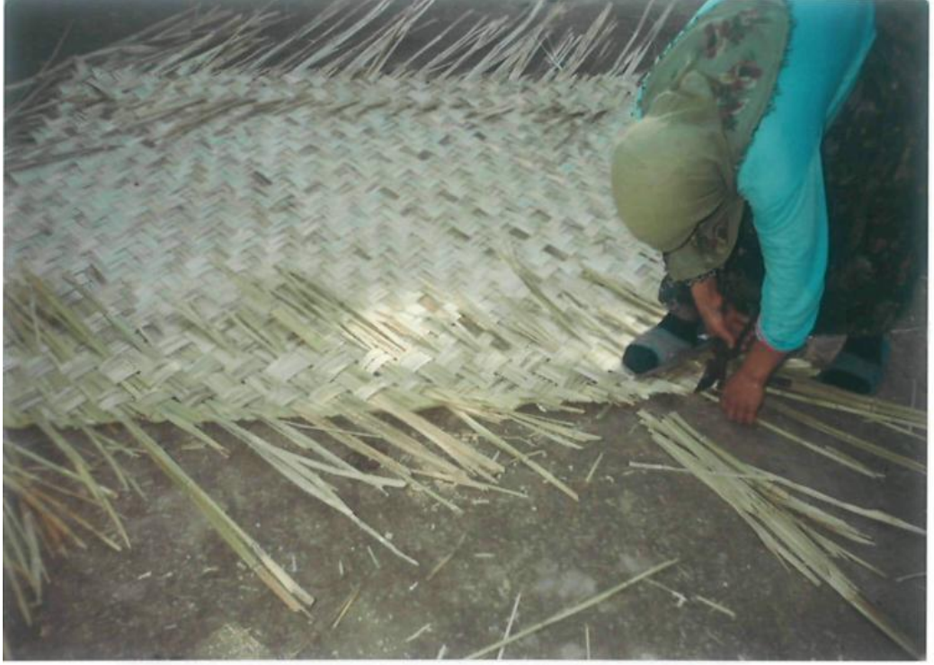
Şekil 4.56 Düz boyra dokuma bitirme işlemi (2) (Doğrugöz Beldesi / Akşehir)
