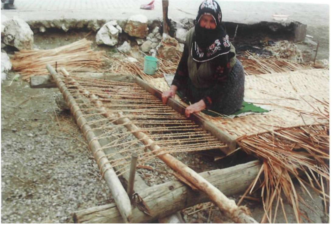
Şekil 4.44. Dokumacının dokuduğu kısma oturarak dokuma yapışı (Yeşildağ Beldesi / Beyşehir)
