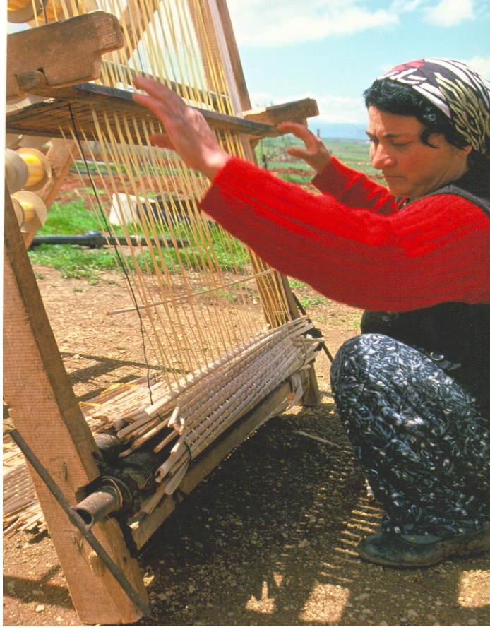
Şekil 4.45 Dikey taşınabilir ahşap tezgahta seccade dokuma (Mutlu Köyü/Hüyük)
