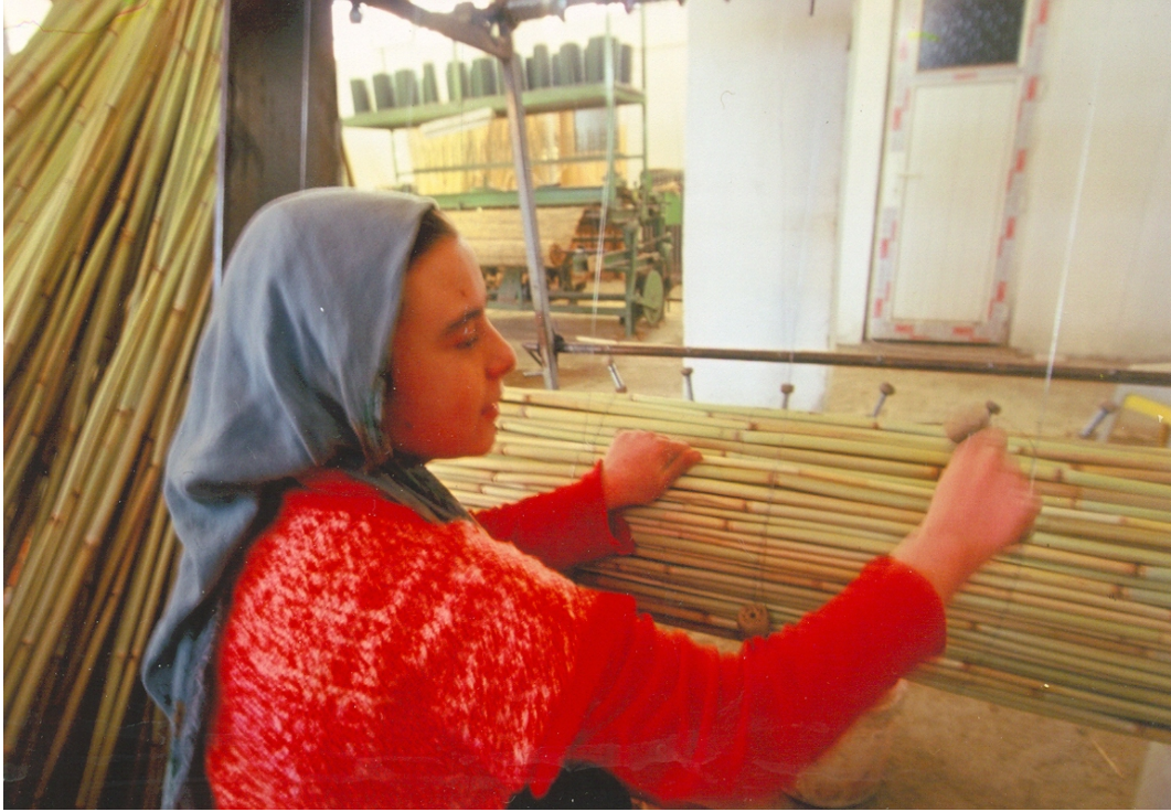
Şekil 4.49 Telli boyra dokuma işlemi (Doğrugöz Beldesi / Akşehir)
