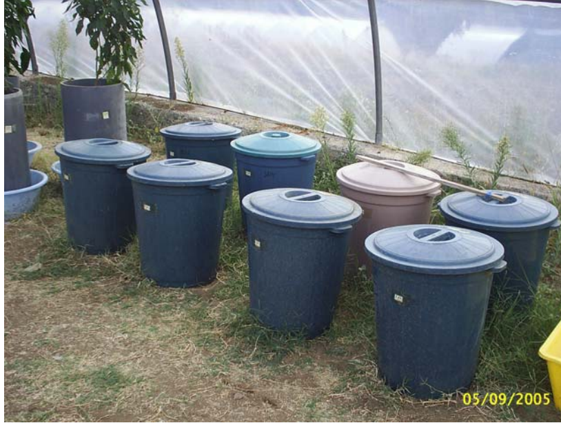
Şekil 3.3 Farklı tuzlar kullanılarak farklı tuzluluk düzeylerindeki sulama sularının hazırlandığı 40 litrelik plastik kovalardan görünüş
