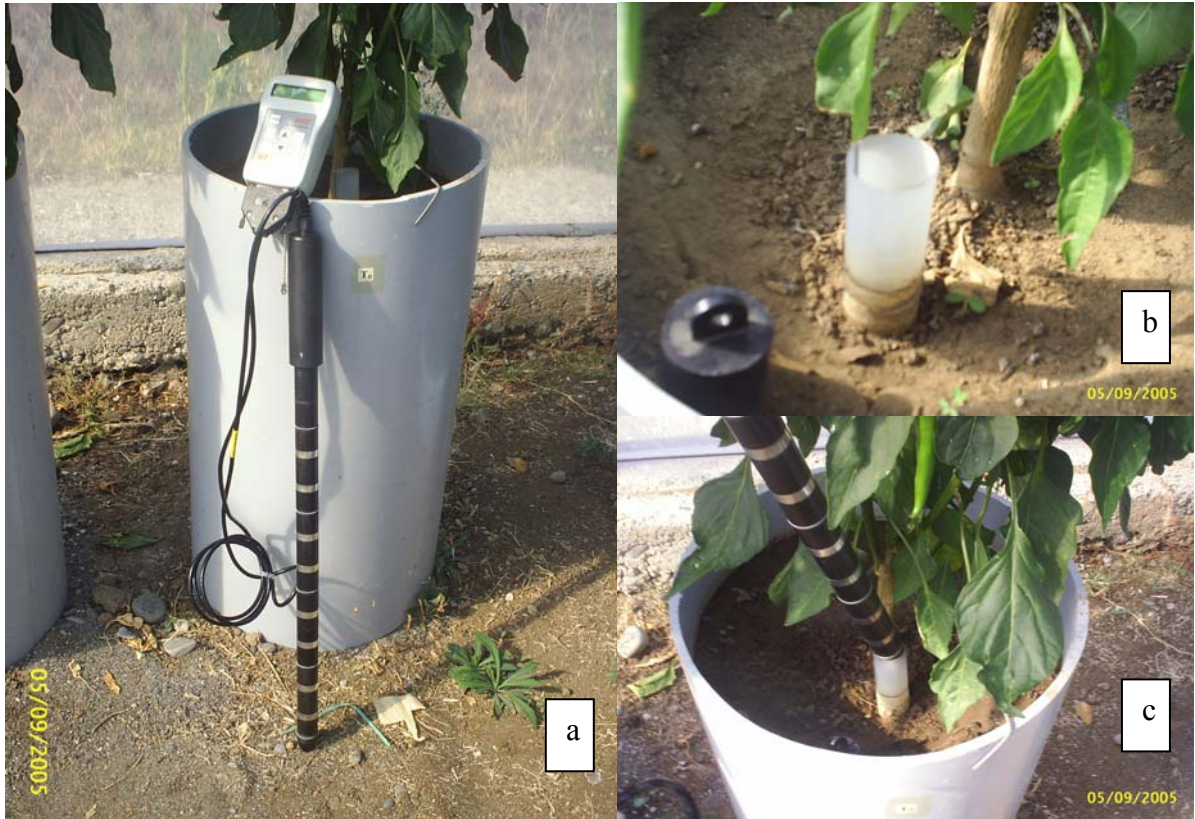
Şekil 3.4 Nem ölçer (Profil prob) ve dijital ölçüm cihazının görünüşü (a); Nem ölçümlerinin yapıldığı plastik kılıf (b); Prob ve plastik kılıfın ölçüm için hazırlanışı (c)
