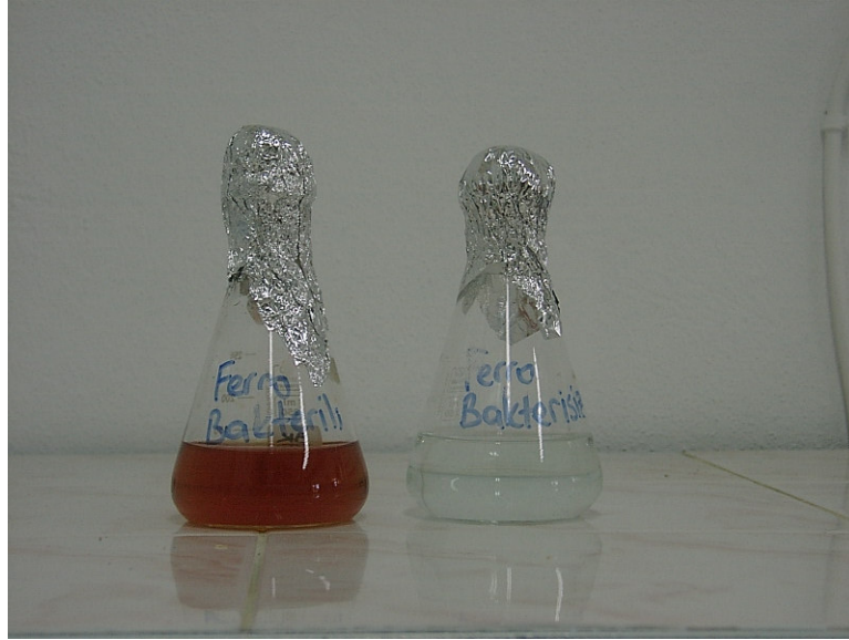
Şekil 3.1. Acidithiobacillus ferrooxidans 7 gündeki Demir Oksidasyonu
