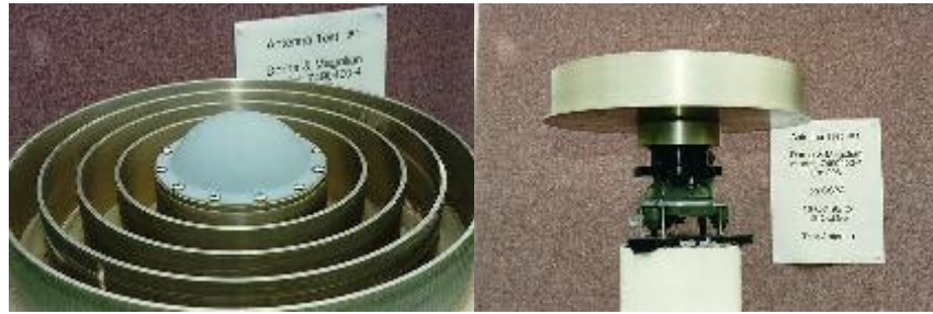
Şekil 6.6: ANKR Sabit GPS İstasyonunda Kullanılan GPS Anteni
