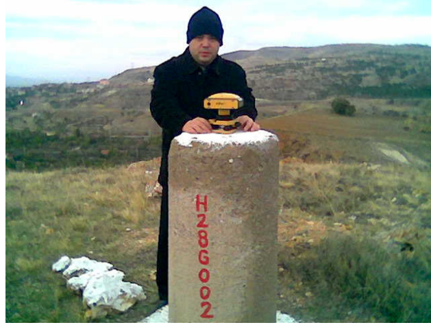
Şekil 6.5: AYAS TUTGA Noktasında Yapılan GPS Ölçüsü
