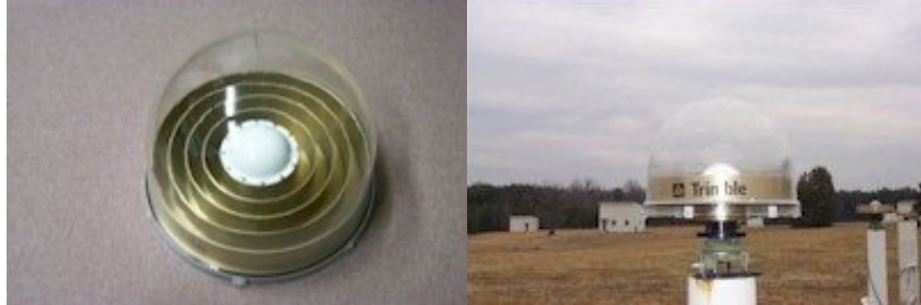
Şekil 6.8: TUBİ Sabit GPS İstasyonunda Kullanılan GPS Anteni
