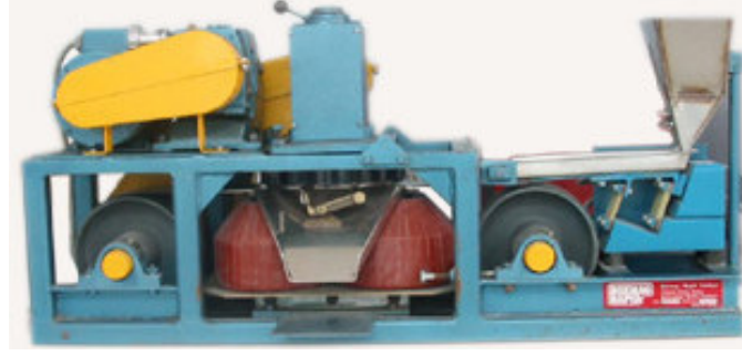
Şekil 3.31: Manyetik ayırma deneylerinde kullanılan yüksek alan şiddetli tek diskli elektromanyetik ayırıcı
