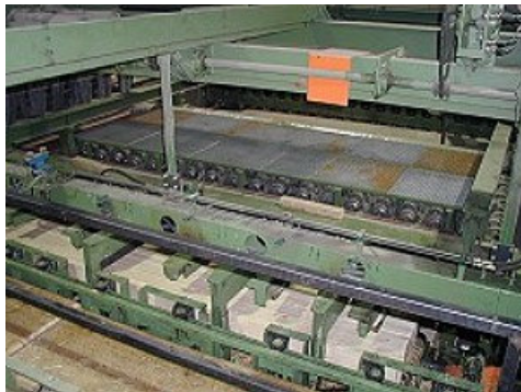
Şekil 2.15: Ağaç tutkalamada kullanılan kontinü tip mikrodalga pres[52-143]
