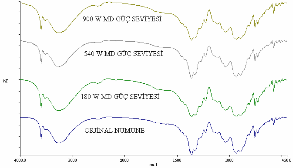
Şekil 3.13:Orijinal ve işlem görmüş kolemanit numunelerinin toplu FT-IR analiz sonuçları
