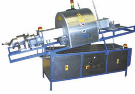
Şekil 2.12: Döner tüplü mikrodalga fırın[52-143]
