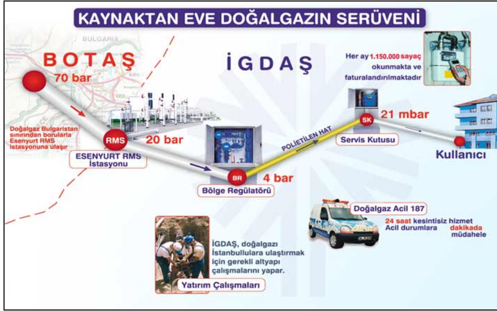
Şekil 1.27. Kaynaktan eve doğalgazın izlediği yol
