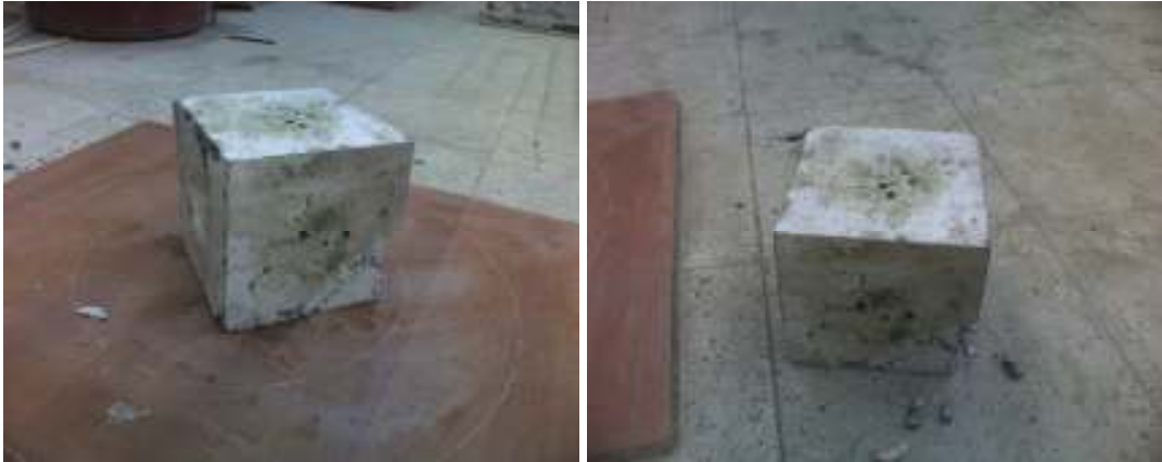
Şekil 8.4 50 °C’de bekletilen küp numunelerin kırılmadan sonraki durumu
