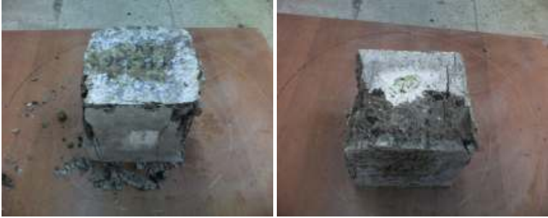
Şekil 8.3 -30 °C’de bekletilen küp numunelerin kırılmadan sonraki durumu
