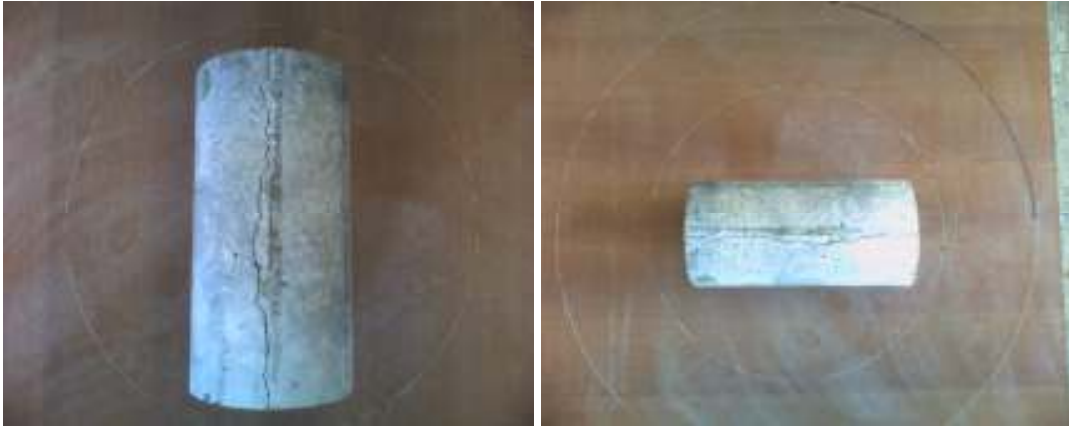
Şekil 8.6 -30\text{ }^{\circ}\text{C} 'de bekletilen silindir numunelerin kırılmadan sonraki durumu
