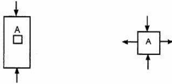
Şekil 7.13 Basınç yükü nedeniyle oluşan çekme kuvveti
