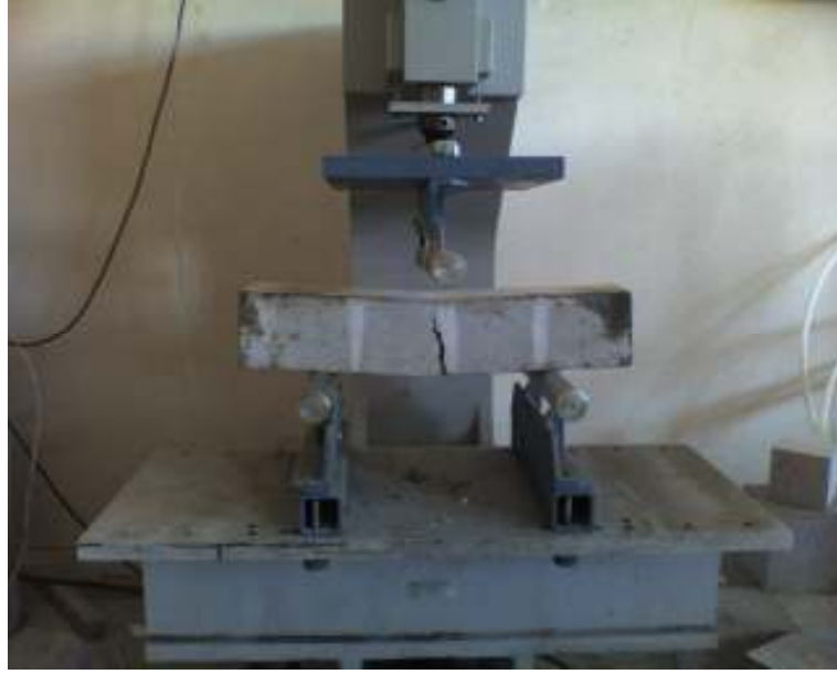
Şekil 8.8 Eğilme dayanımı deney düzeneği
