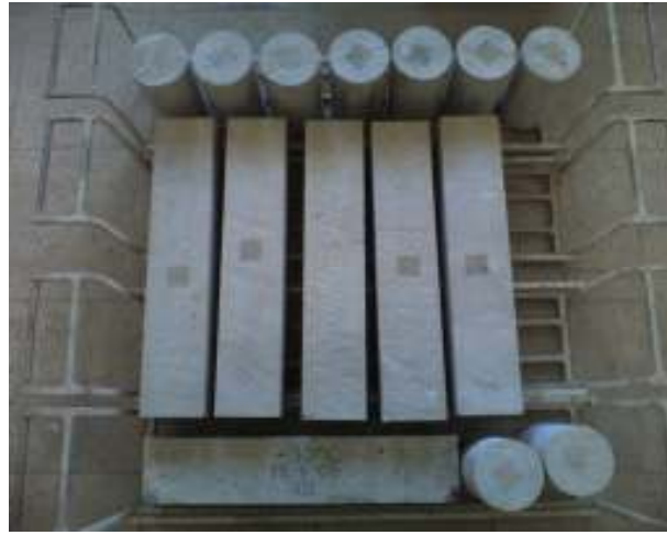
Şekil 7.1 Laboratuvar ortamında 24 saat bekletilen numuneler
