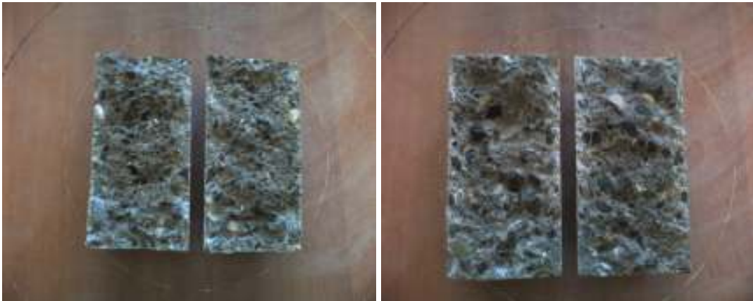
Şekil 8.7 -30\text{ }^{\circ}\text{C} 'de bekletilen silindir numunelerin kırılmadan sonra iç yüzeyleri
