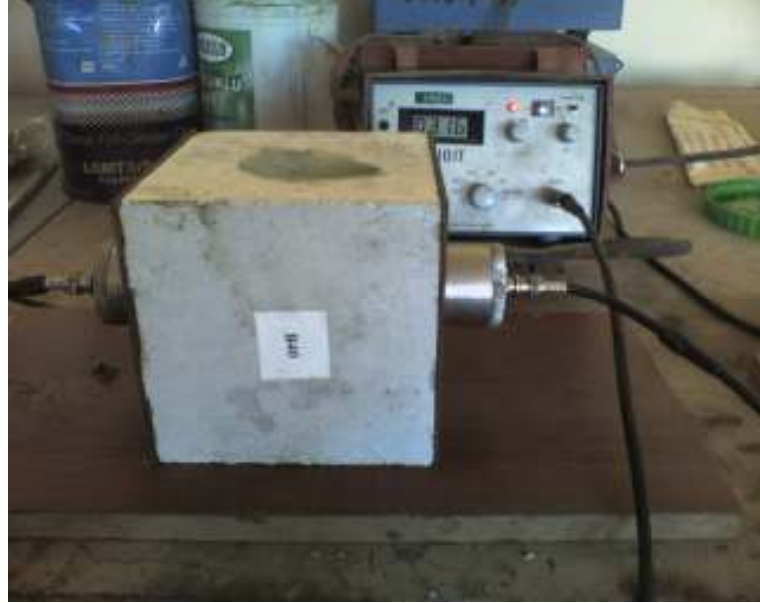
Şekil 7.4 Deneylerde kullanılan pundit aleti
