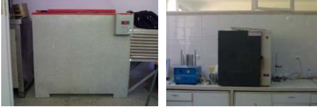
Şekil 7.2 Deney çalışmasında kullanılan dondurucu ve etüv
