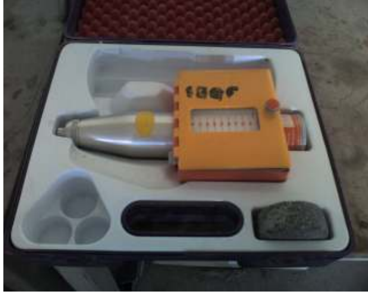
Şekil 7.5 Deneylerde kullanılan schmidt çekici
