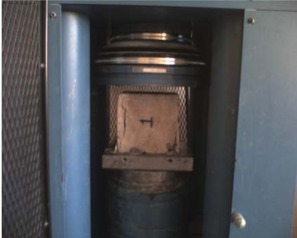
Şekil 8.1 Basınç dayanım deney düzeneği
