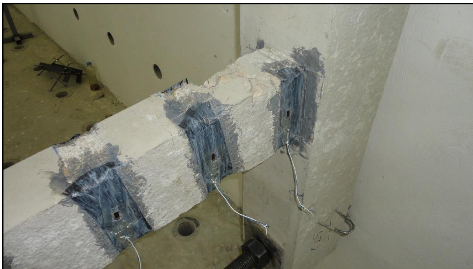
Şekil 4.35. S3 deney elemanına yapıştırılan strain gauge'ler.
