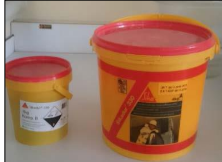
Şekil 3.2. Deneysel çalışmada kullanılan çift bileşenli epoksi.
