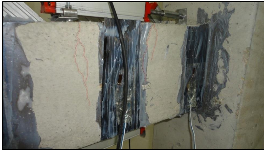
Şekil 4.10. S1 deney elemanında meydana gelen çatlak gelişimi.
