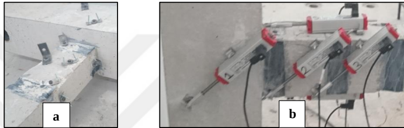
Şekil 3.15. Metal kanca ve potansiyometrik cetvellerin numuneye uygulanması.
