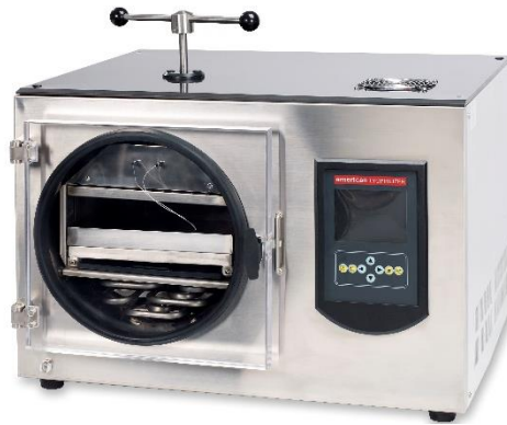
Şekil 2-31: Banko üstü liyofilizatör (American Lyophilizer Inc., A.B.D.).
