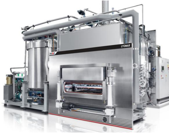
Şekil 2-29: Endüstriyel liyofilizatör (Lyomax, IMA Life, İtalya).
