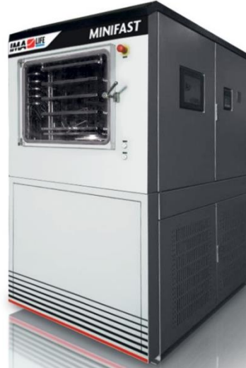
Şekil 2-30: Pilot liyofilizatör (Liyofast, IMA Life, İtalya).
