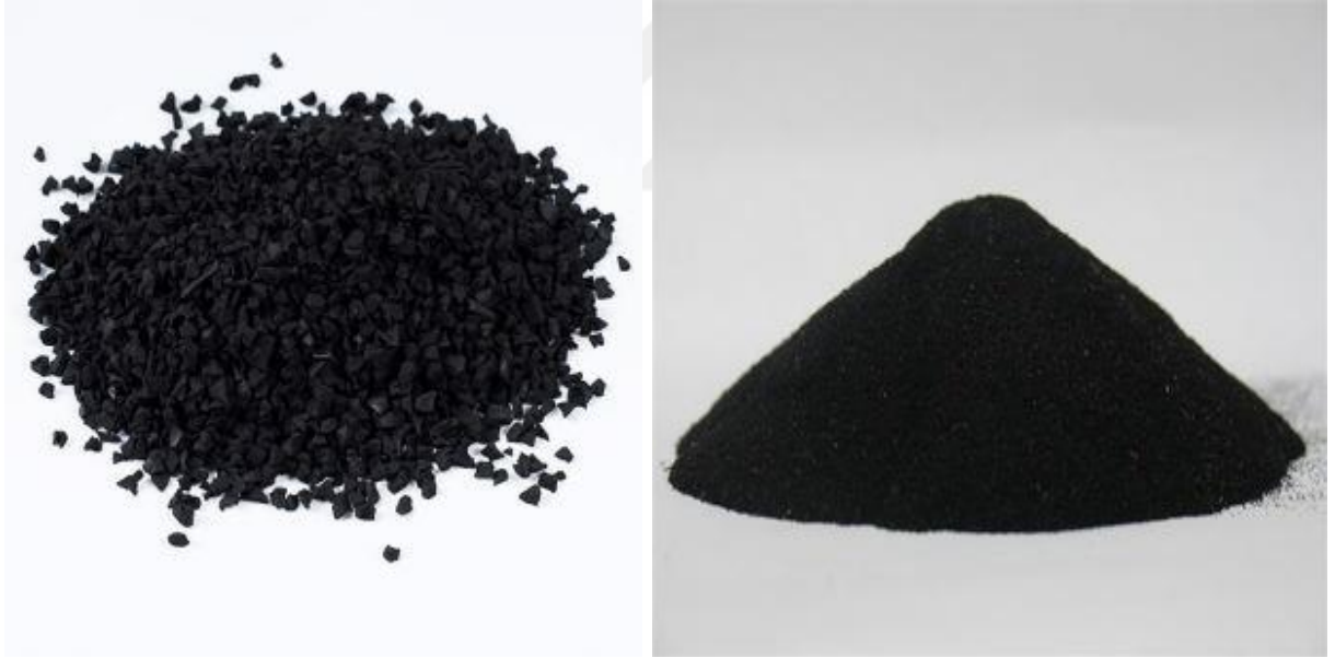
Şekil 3.1. Granül atık lastiklerin elenme öncesi ve eleme sonrası görüntüleri
