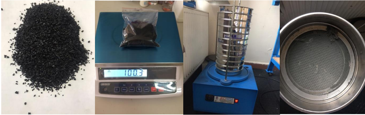
Şekil 3.3. Elek analizi işlemi
