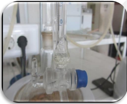
Şekil 3.6. Clevenger cihazı (titrasyon musluğu)
