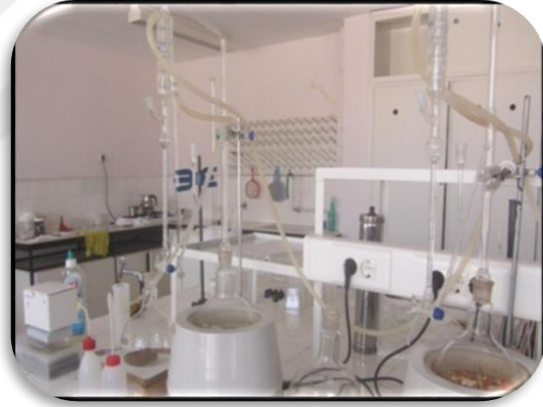
Şekil 3.7. Clevenger cihazı genel görünüm
