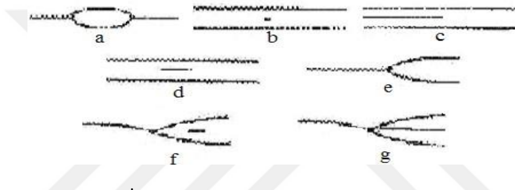
Şekil 1.2: Parmak İzi Eşleştirmede Tanımlanmış Hat Karakteri Modelleri (a, ada; b, nokta; c, Hat Sonu; d, Kısa Hat; e, Çatal; f, Delta; g, Üçlü Çatal Model) (Barutçu, 2008).
