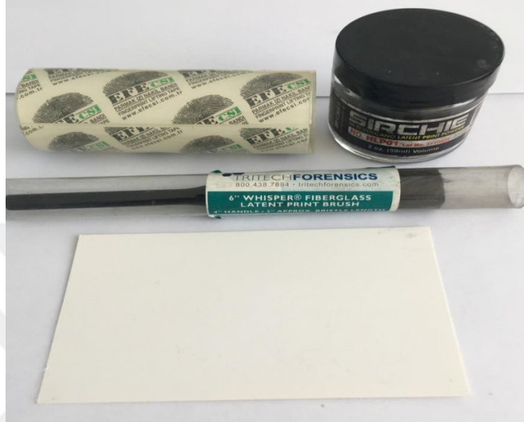
Şekil 2.5 tozlama ve iz transferinde kullanılan malzemeler
