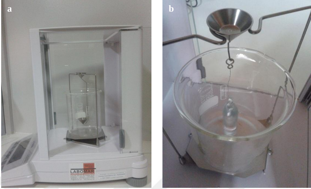
Şekil 2.8 Archimed prensibine göre yoğunluk ölçüm sistemi
