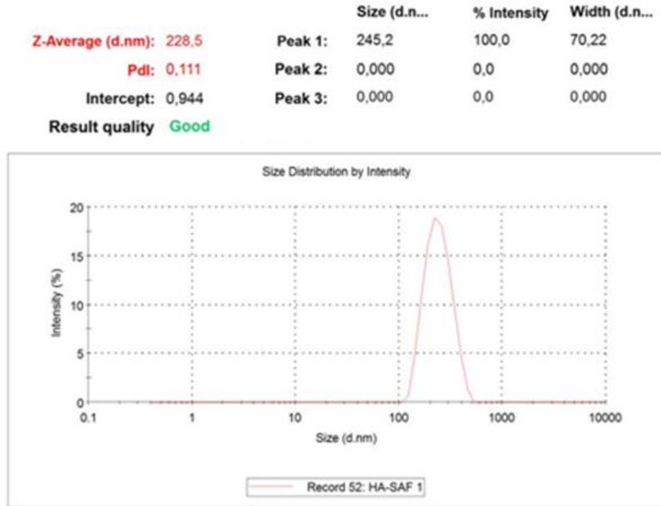
Şekil 3.10 Katkısız HAp Zetasizer Analiz Sonucu
