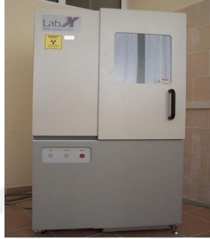
Şekil 2.4 SHIMADZU 6000 model XRD cihazı
