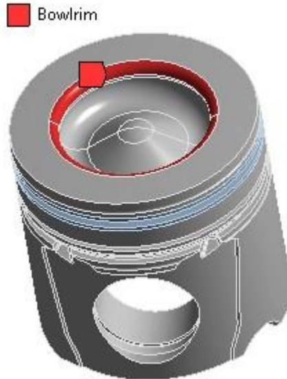
Şekil 3.10 Piston üst yüzeyindeki büküm bölgesi (bowlrim)
