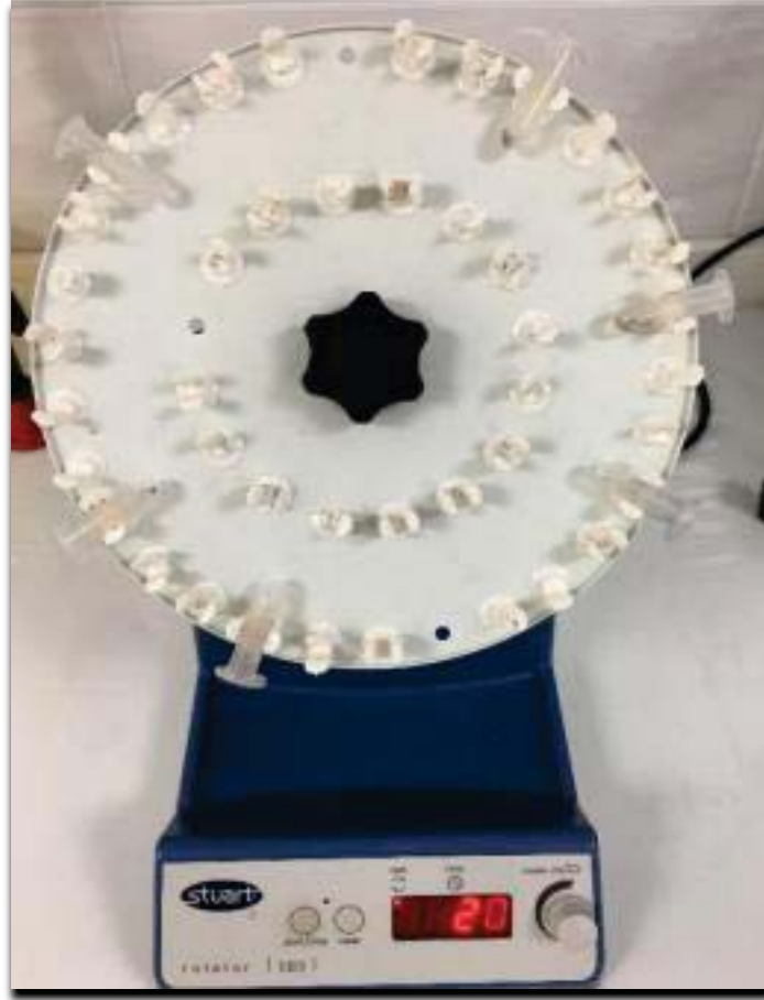
Şekil 4.9. Cyt- MIP sentezlenmiş manyetik nanokürelerle uzaklaştırma sistemi.
