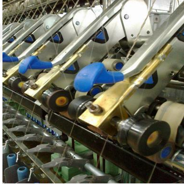
Şekil 3.1. Ring İplik Makinesinde çekim sistemi ve özlü iplik aparatı
