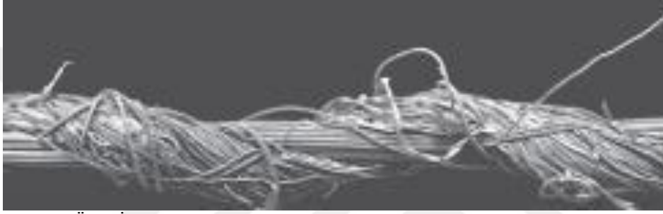
Şekil 1.2. Özlü İplik Yapısı
