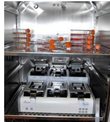
Şekil 4.2. Tobramisin ve sinamaldehitin sub-MIC konsantrasyonlarının P. aeruginosa PA01'in biyofilm oluşumu üzerindeki etkisinin xCELLigence cihazı ile tespiti.
