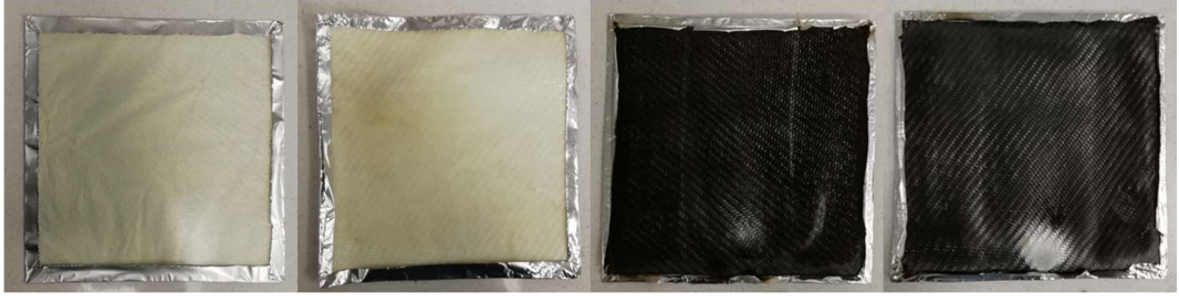
Şekil 4.9. Soldan sağa sırasıyla; %5 IFR36 içeren test öncesi, %5 IFR36 +Antibakteriyel işlem görmüş test öncesi, %5 IFR36 içeren test sonrası, %5 IFR36 +antibakteriyel işlem görmüş test sonrası numunelerinin görselleri
