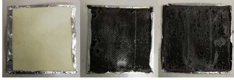
Şekil 4.7. Soldan sağa sırasıyla; %15 AP750 +Antibakteriyel işlem görmüş test öncesi, %15 AP750 içeren test sonrası, %15 AP750+antibakteriyel işlem görmüş test sonrası numunelerinin görselleri
