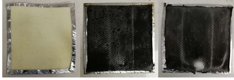
Şekil 4.6. Soldan sağa sırasıyla; %10 AP750 +Antibakteriyel işlem görmüş test öncesi, %10 AP750 içeren test sonrası, %10 AP750+antibakteriyel işlem görmüş test sonrası numunelerinin görselleri
