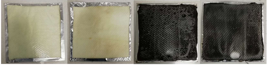
Şekil 4.10. Soldan sağa sırasıyla; %10 IFR36 içeren test öncesi, %10 IFR36 +Antibakteriyel işlem görmüş test öncesi, %10 IFR36 içeren test sonrası, %10 IFR36 +antibakteriyel işlem görmüş test sonrası numunelerinin görselleri
