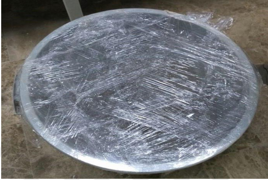
Resim 3.3 Tuğla hamurunun 24 saat hava almayacak şekilde dinlendirilmesi
