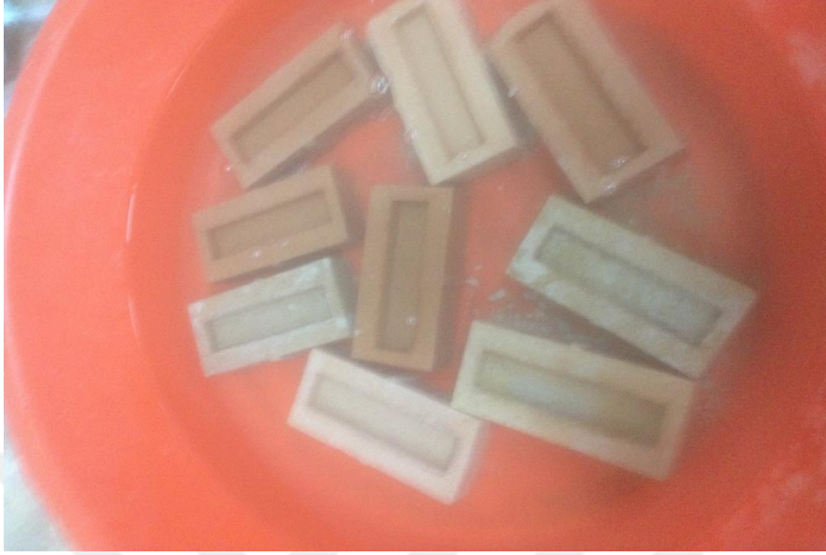
Resim 4.5 Pişirilen tuğlaların 24 saat suda bekletilmesi
