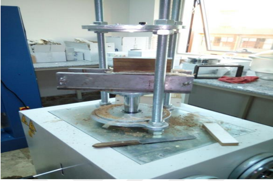
Resim 3.5 Hidrolik pres makinesinden ham tuğlanın çıkarılması
