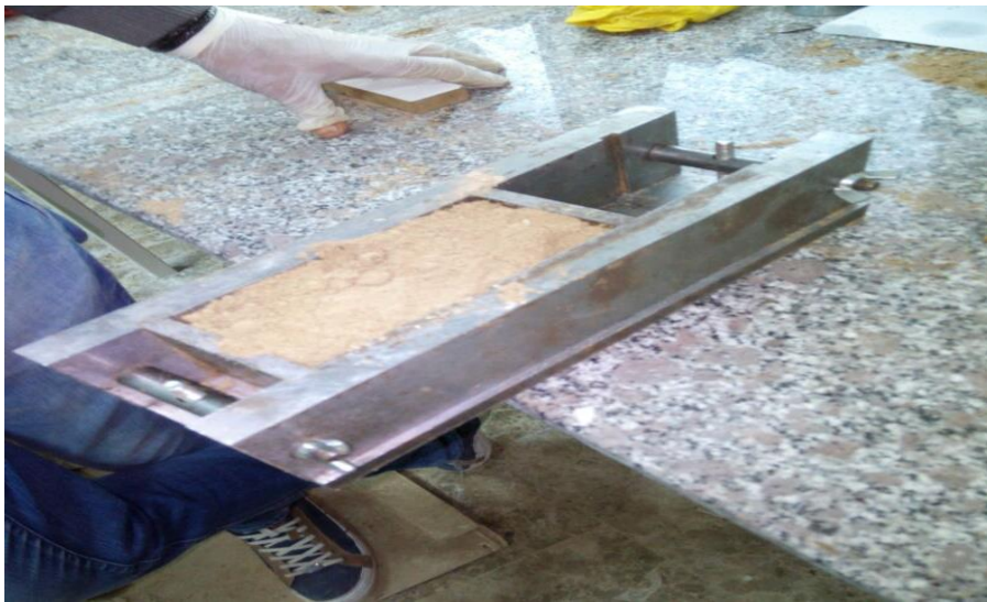
Resim 3.4 Çelik tuğla kalıbına toprağın dökülmesi
