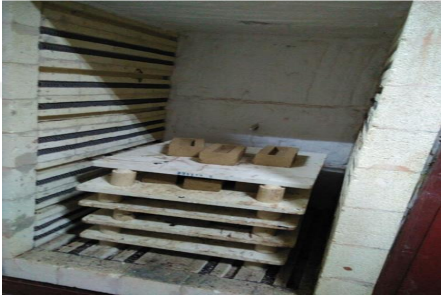
Resim 3.7 Tuğlaların yüksek fırına yerleştirilmesi
