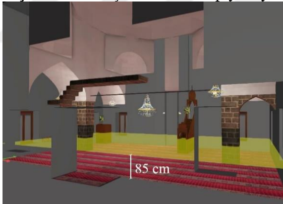
řekil 2.2 Diz üstü oturan cemaatin göz yüksekliđinden geçen yatay düzlem
